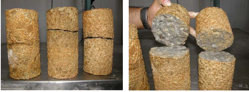
Resim 4.2. H_2SO_4 etkisindeki beton örnekleri deformasyon şekli
