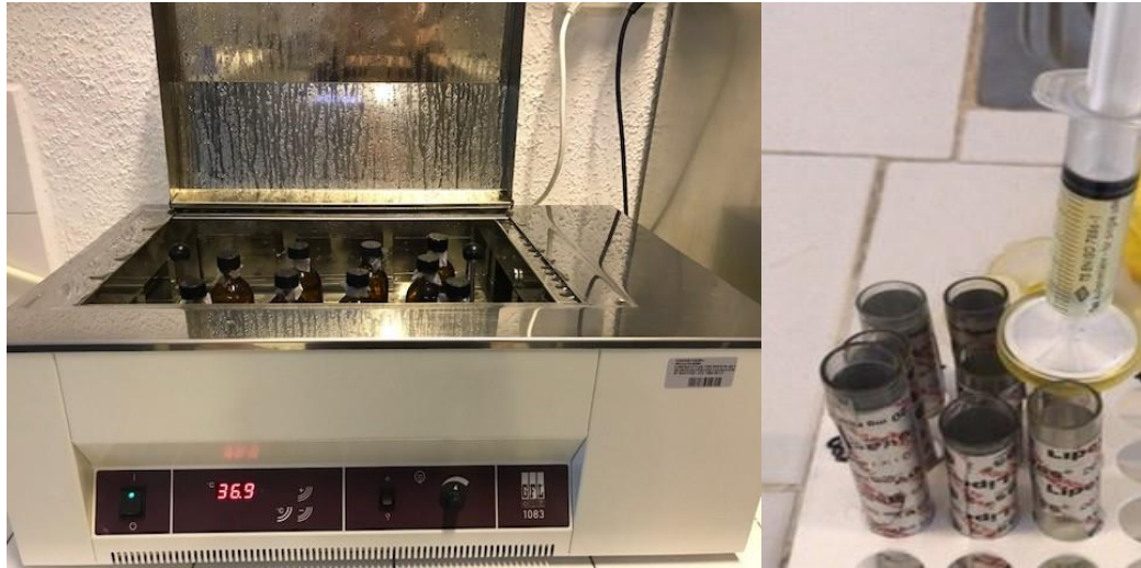
Resim 3. Çözünürlük çalışması düzeneği ve numune alma işlemi.
