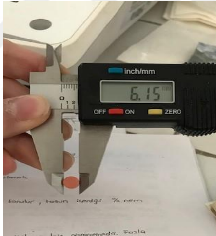
Resim 4. Dijital kumpas kullanılarak tablet çapının ölçülmesi.
