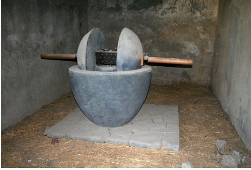
Şekil 18: Trapetum düzeneği ve detayı. Kaynak: https://bit.ly/3LpbdZt
