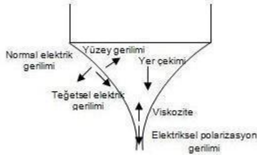
Şekil 1.5. Taylor konisinin oluşumuna etki eden kuvvetlerin şematik gösterimi.
