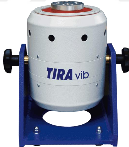
Şekil 2.1: Sarsıcı – Elektro-Mekanik Dinamik Test Tezgahı.
