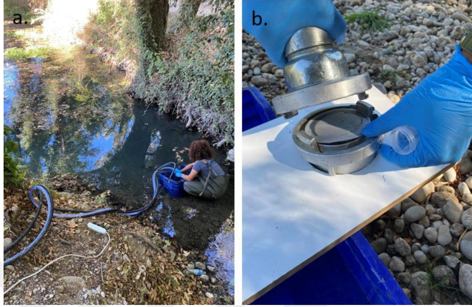
Şekil 2. Örnekleme düzeneği pompa (A) ve süzme (B) kısımları.
