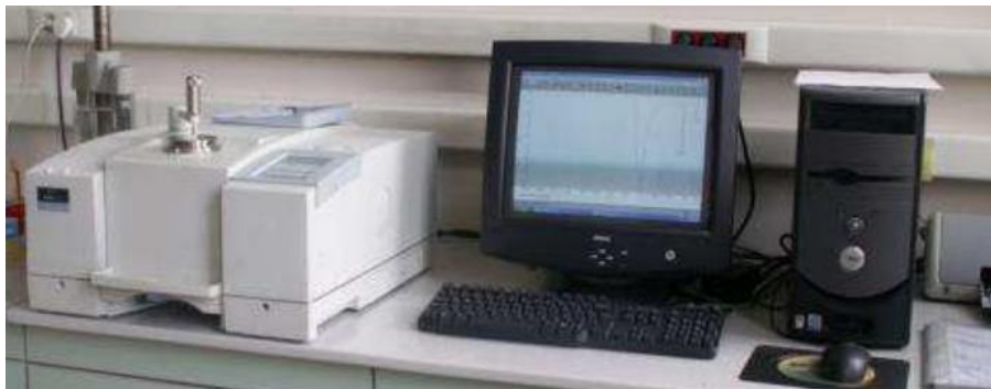
Şekil 45. Fourier dönüşümlü kızılötesi spektrometresi (FTIR) (Yıldız, 2012).
