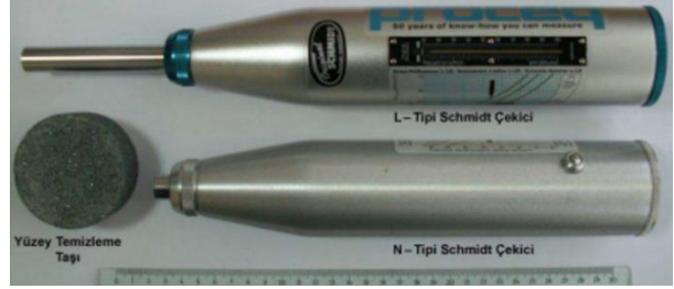
Şekil 30. Schmidt test çekici (Aksoy ve Karaton, 2019) ve Şekil 31. Schmidt sertlik çekiçleri (Yıldız, 2012).
