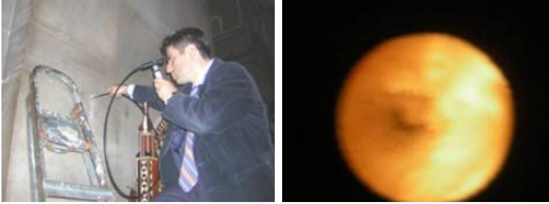
Şekil 35. Endoskopik yöntemin yapıda uygulanma görseli (Aköz ve Yüzer, 2009).
