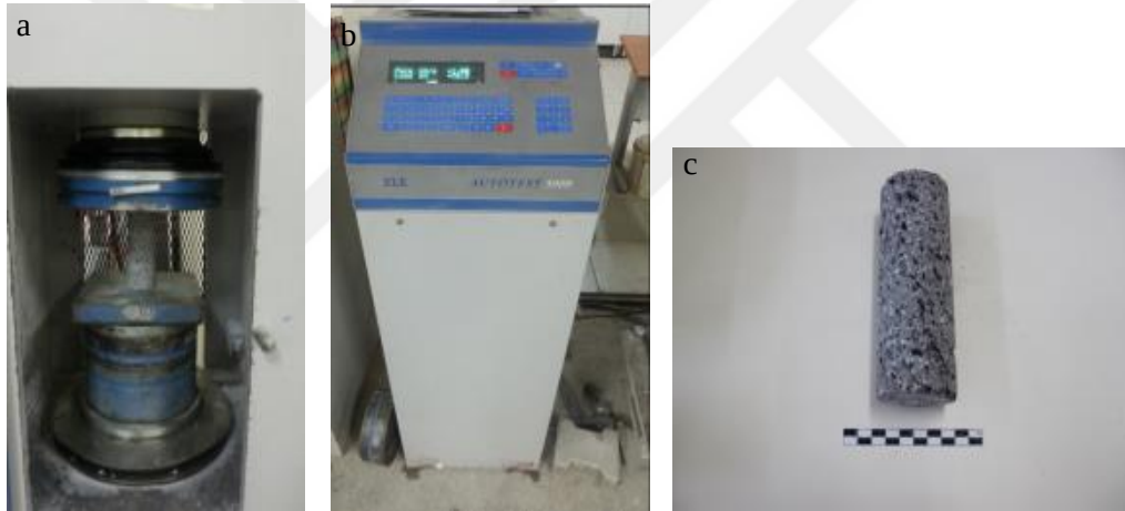
Şekil 46. Tek eksenli basınç deney aşamaları; a) deneyde kullanılan yükleme başlıkları ve pres, b) yükleme hız seçimi, c) örneğin deney sonrası görünümü (Hatır, 2019).
