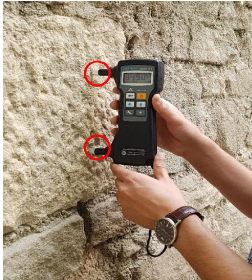
Şekil 32. P-dalga hızı testi uygulamasından bir görünüm (Hatır, 2019).
