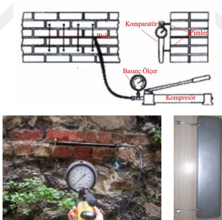
Şekil 37. Plak (200x400x8 mm) ölçüm yöntemi ile yapılan teorik anlatımı ve uygulaması (Aköz ve Yüzer, 2009).
