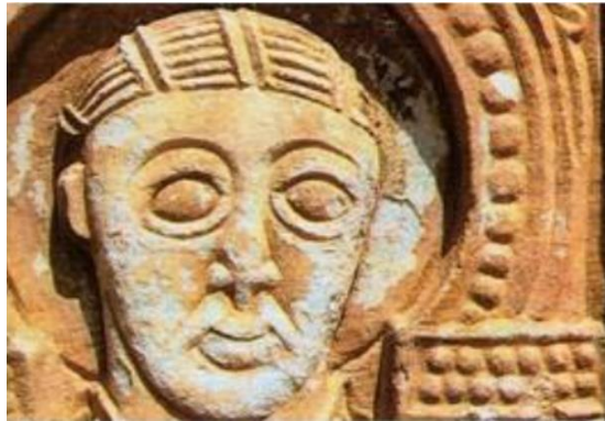
Şekil 21. Mikroorganizmaların sebep olduğu yüzeysel çözünmeler (Dolar ve Yardımlı, 2017).
