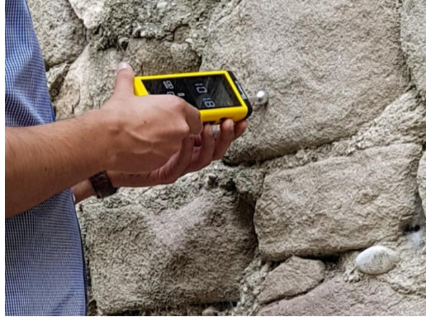
Şekil 27. Yüzey nem ölçüm testi uygulamasından bir görünüm (Hatır, 2019).
