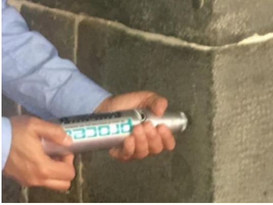
Şekil 30. Schmidt test çekici (Aksoy ve Karaton, 2019) ve Şekil 31. Schmidt sertlik çekiçleri (Yıldız, 2012).
