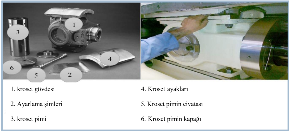
Şekil 39. Kroseti oluşturan parçaları (Bloch, 2006) ve Kobelco kompresörünün kroset donanımında boşluk ölçümü (Kobelco, 2006)
