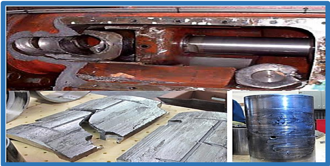
Şekil 46. Kroset donanımının hasarı (Beta machinery, 2015; URL-2,2016).
