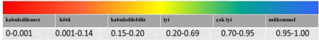
Şekil 3.9. Mesh metrik skalasının ortogonal kalitesi
