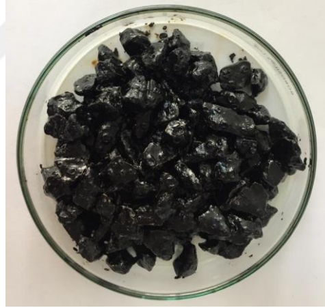
Şekil 37. Petri kabına aktarılmış agrega-bitüm karışımı
