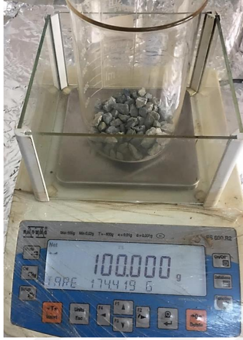
Şekil 36. 100 gr agrega alınması
