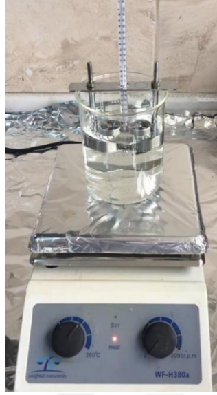
Şekil 16. Yumuşama noktası deney aparatları
