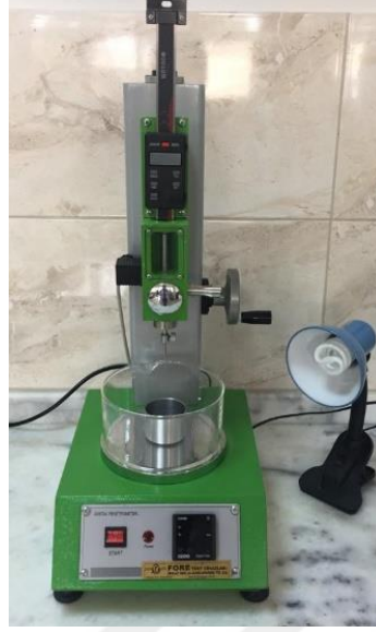
Şekil 15. Penetrasyon deney aleti
