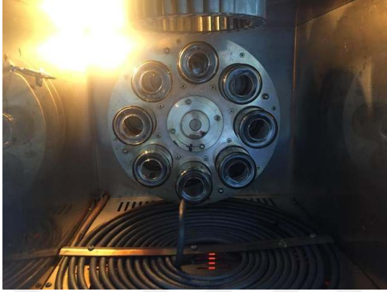
Şekil 40. RTFOT cihazına yerleştirilmiş bitüm numuneleri
