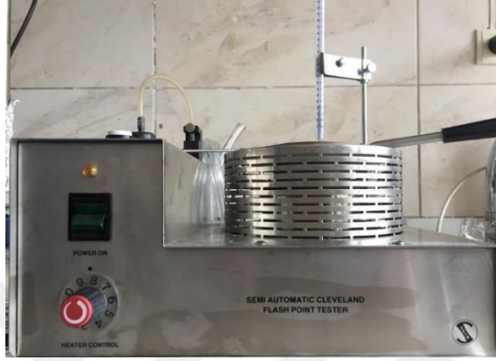
Şekil 17. Cleveland parlama noktası cihazı
