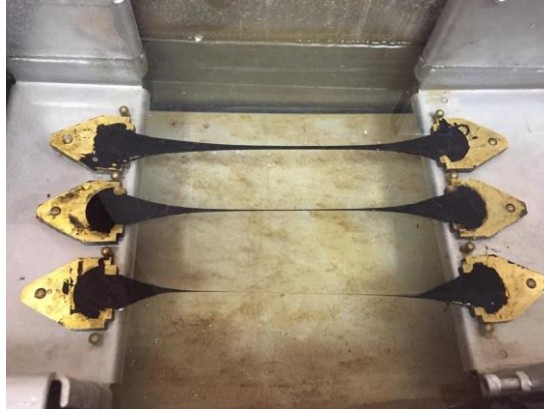
Şekil 35. Düktilite deneyine tabi tutulan numuneler
