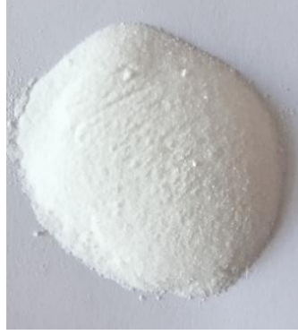
Şekil 29. Bor oksit katkısı
