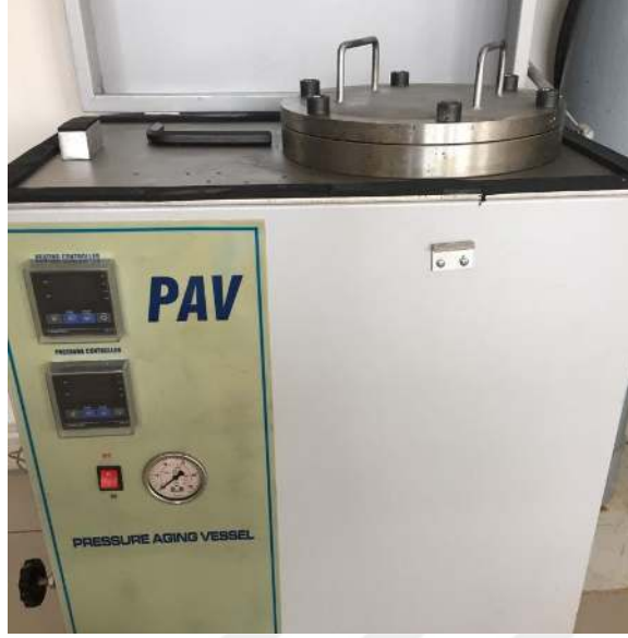
Şekil 20. PAV Deney cihazı
