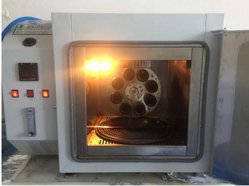
Şekil 19. RTFOT deney cihazı
