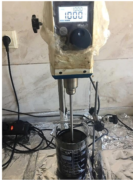
Şekil 30. Modifiye bitümlerin hazırlanması
