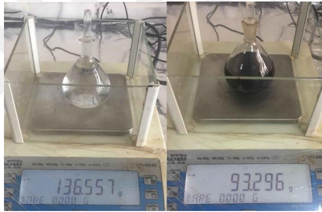
Şekil 38. Su dolu piknometre ve yarısi bitüm dolu piknometre tartımları
