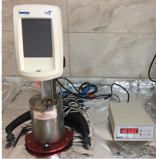
Şekil 18. Dönel viskozimetre deney cihazı
