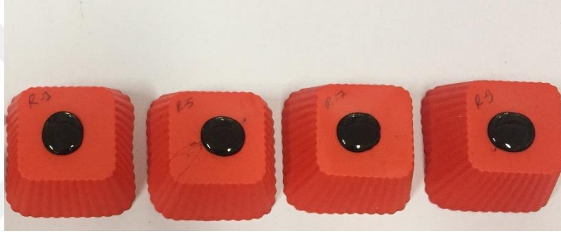
Şekil 41. DSR deneyi için hazırlanan numuneler
