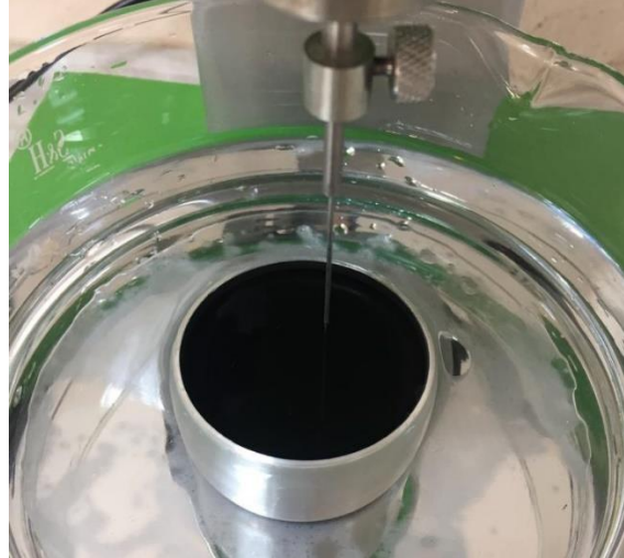
Şekil 32. Penetrasyon iğnesinin numune yüzeyine indirilmesi
