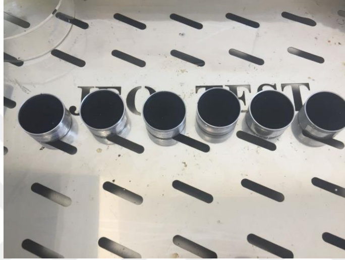
Şekil 31. Su banyosunda bekletilmekte olan bitüm numuneleri
