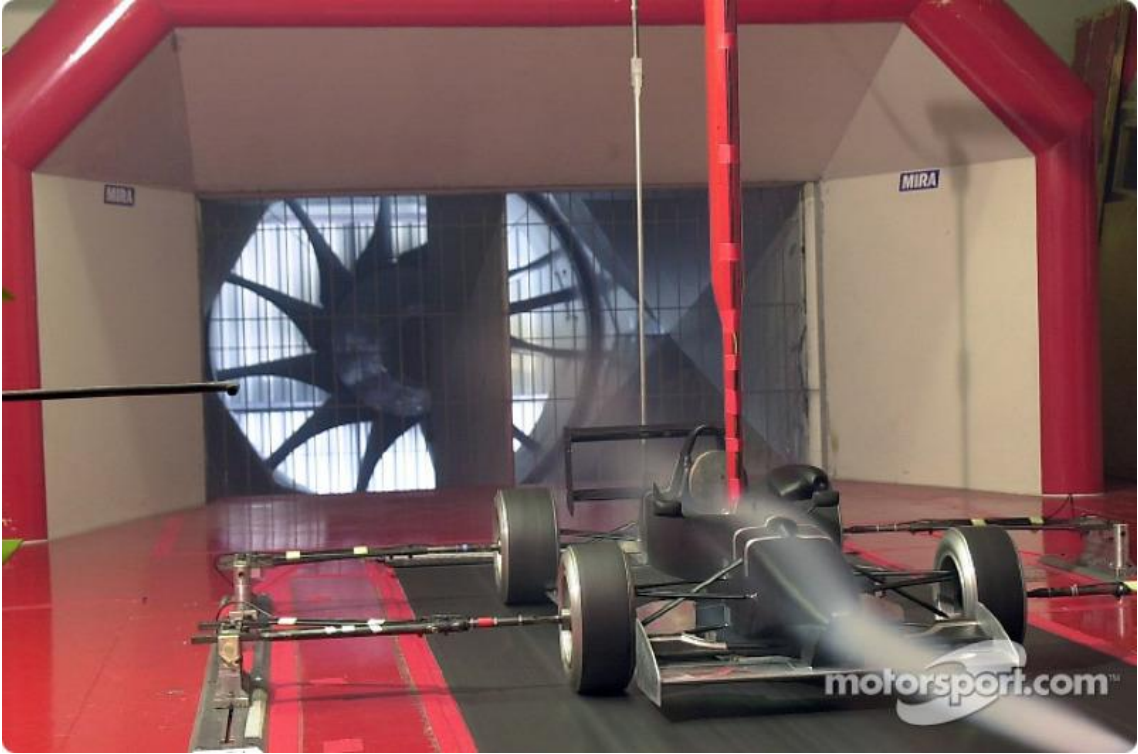
Şekil 1.11. Rüzgar tüneli testlerinde yol simülasyonunun uygulanması için geliştirilmiş bant sisteminde model aracın sabitlenmesi ( https://www.motorsport.com , 17.05.2019).
