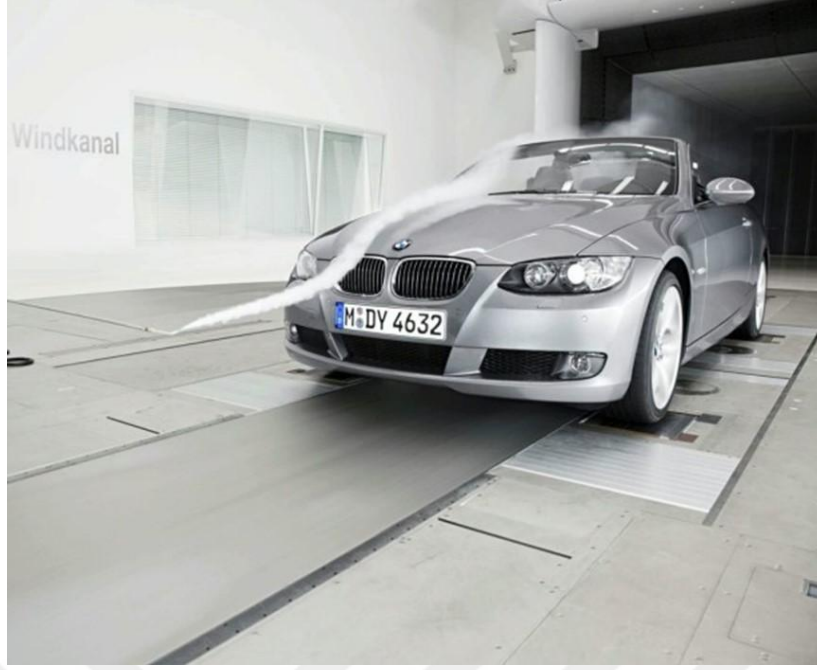
Şekil 1.6. Rüzgar tüneli testinde duman yöntemi ile akım görselleştirme ( https://www.bmwblog.com , 17.05.2019).
