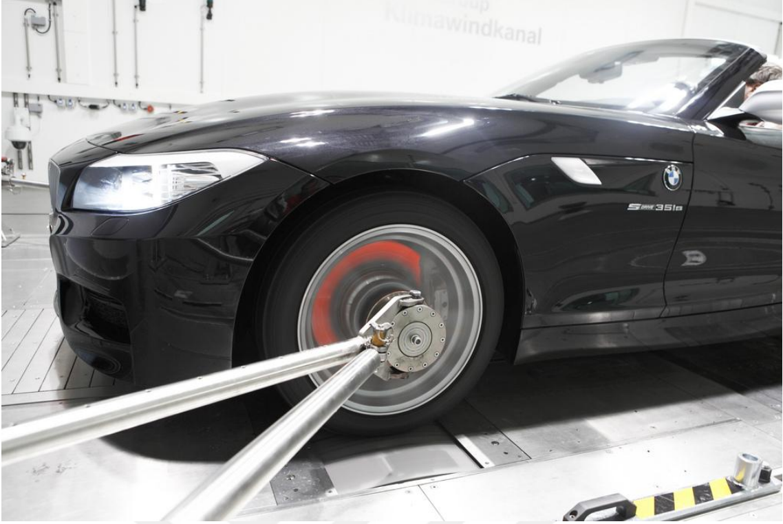
Şekil 1.12. Rüzgar tüneli testlerinde yol simülasyonunun uygulanması için geliştirilmiş dar bant sistemi ( https://www.bmw-sg.com , 17.05.2019).
