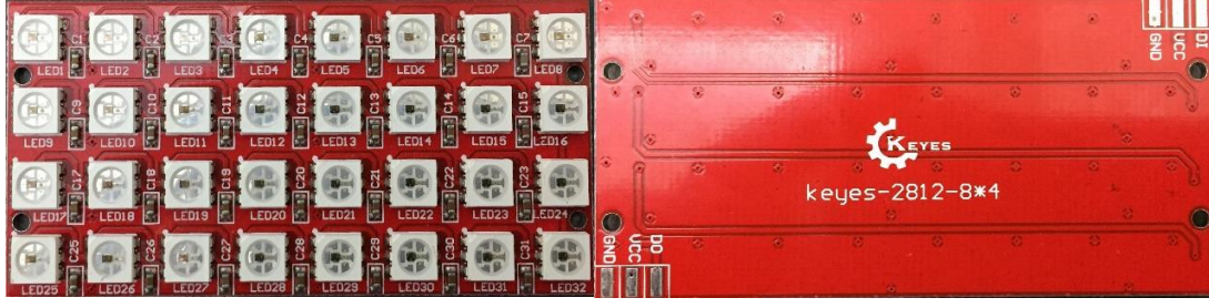
Şekil 3.1 8x4 5050 RGB LED modül kartının arka ve ön tarafı.
