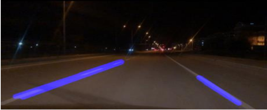
Şekil 4.15 Şerit çizgilerin tespit edilmesi.
