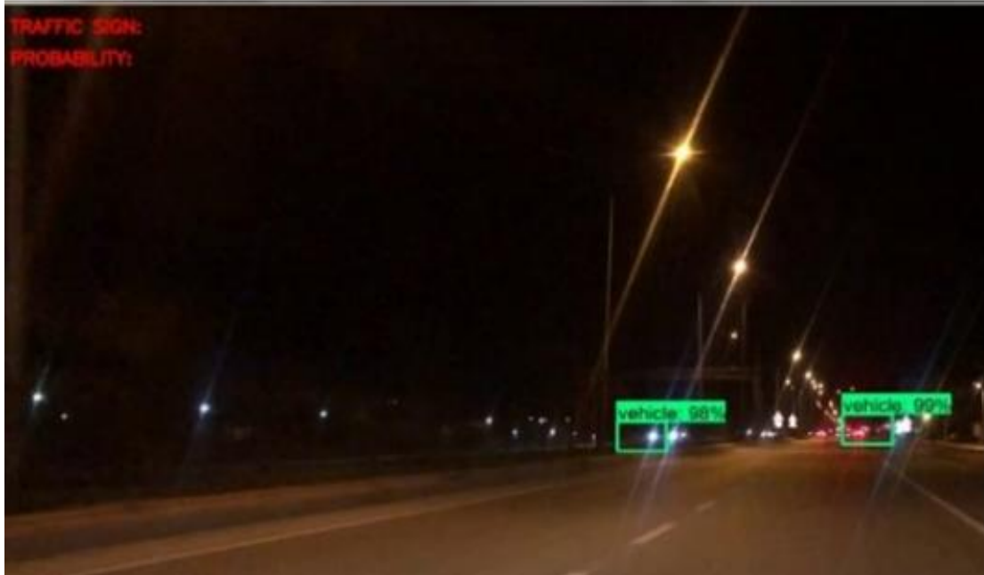
Şekil 4.3 Araç tanıma ve uzun far sistemi.
