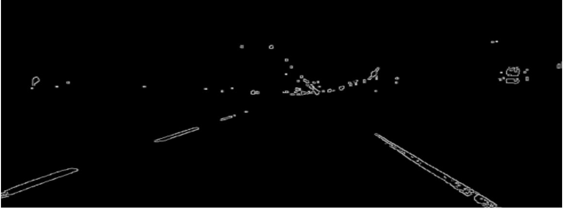
Şekil 4.9 Canny ile kenar tespiti.
