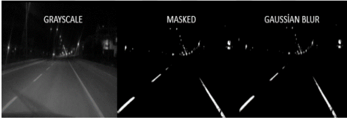
Şekil 4.8 Görüntü filtreleme proses adımları.
