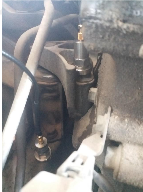
Őekil 3.23 Motor takozundaki titreőimi lm ve cihazın baėlantı őekli
