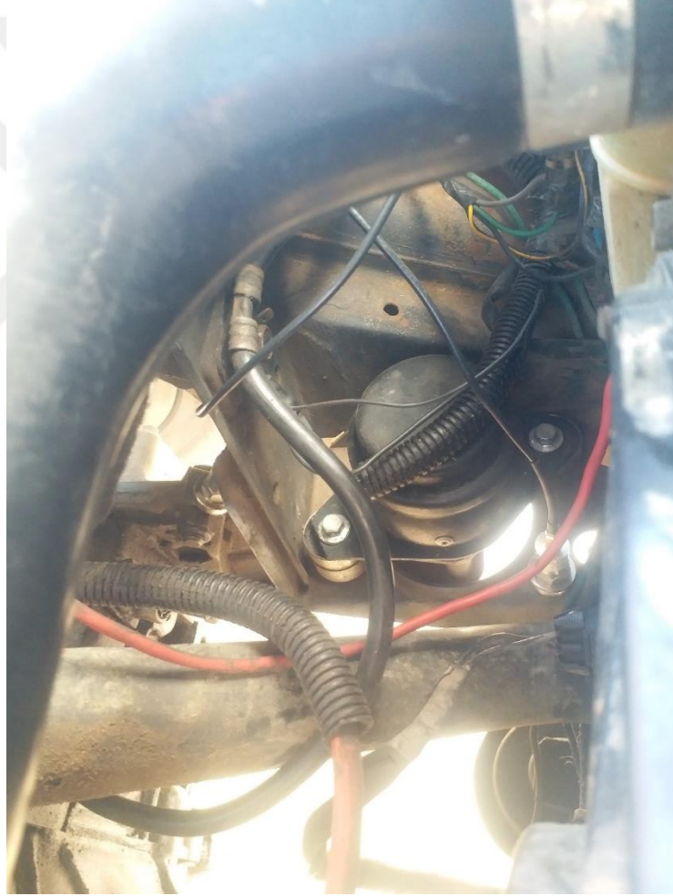
Şekil 4.14 Belirlenen hidrolik takozun araç üzerine montajı ve cihaz bağlantısı
