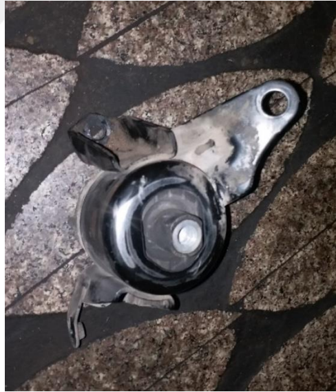
Şekil 3.25 Deforme olmuş takozun görüntüsü
