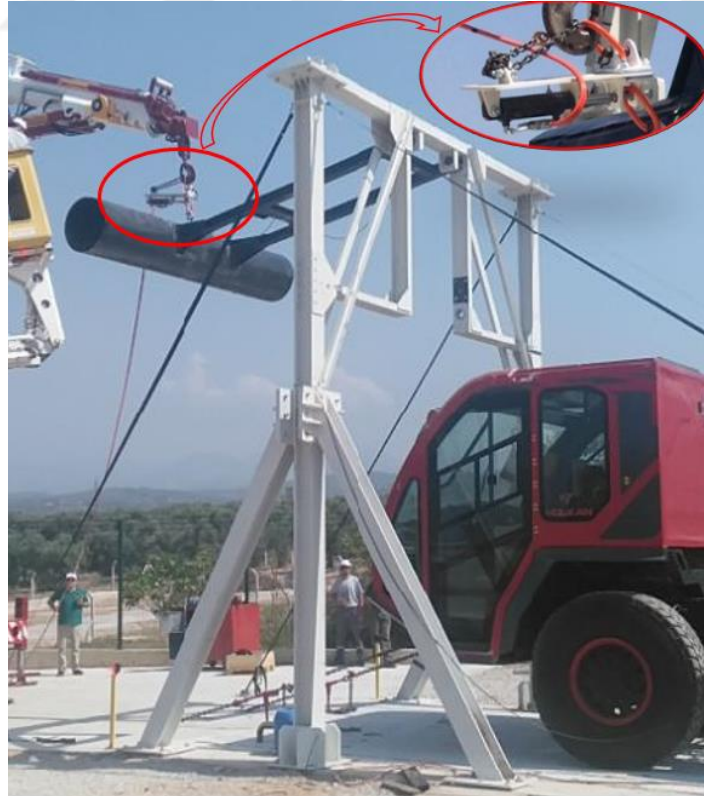
Şekil 3.5 Ön A sütunu testi (B testi) düzeneği ve kanca mekanizması (Kişisel arşiv, 2019)
