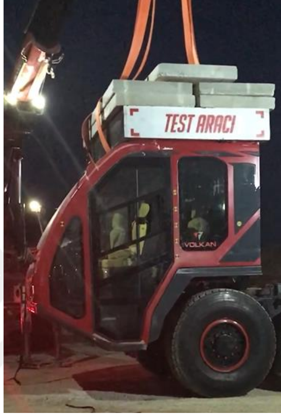
Şekil 5.5 Test aracının tavan dayanımı testi uygulaması (Kişisel arşiv, 2019)
