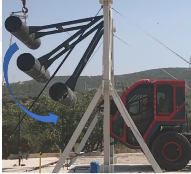
Şekil 5.1 Sabitlenmiş test aracının ön a sütunu çarpma testi uygulaması (Kişisel arşiv, 2019)
