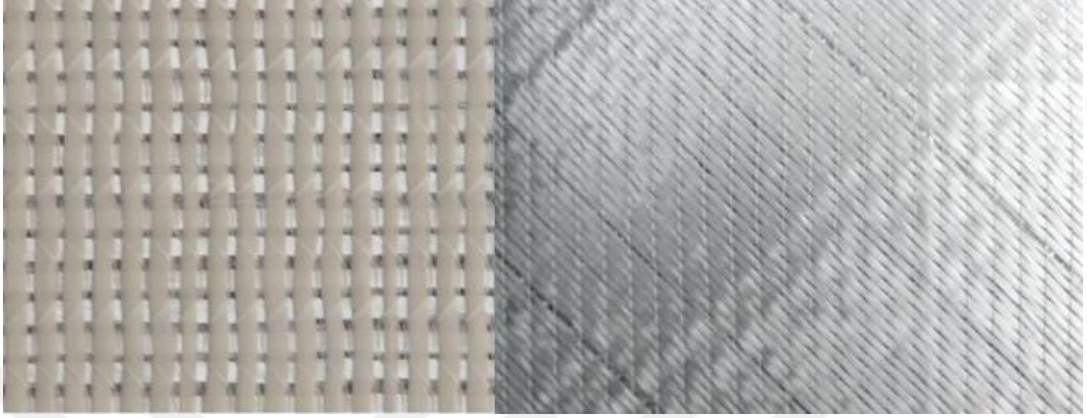
Şekil 4.3 0^{\circ}/90^{\circ} (solda) ve +45^{\circ}/-45^{\circ} (sağda) açılı biaxial cam elyaf örgüler (Cam Elyaf San., 2003)
