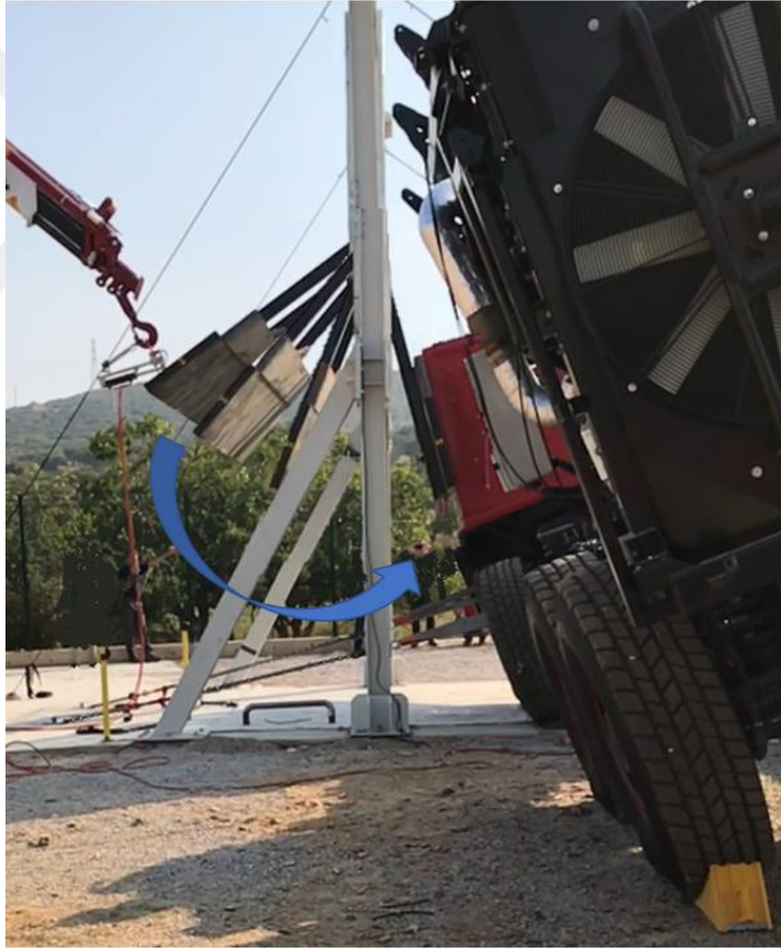
Şekil 5.3 Sabitlenmiş test aracının yandan darbe testi uygulaması (Kişisel arşiv, 2019)
