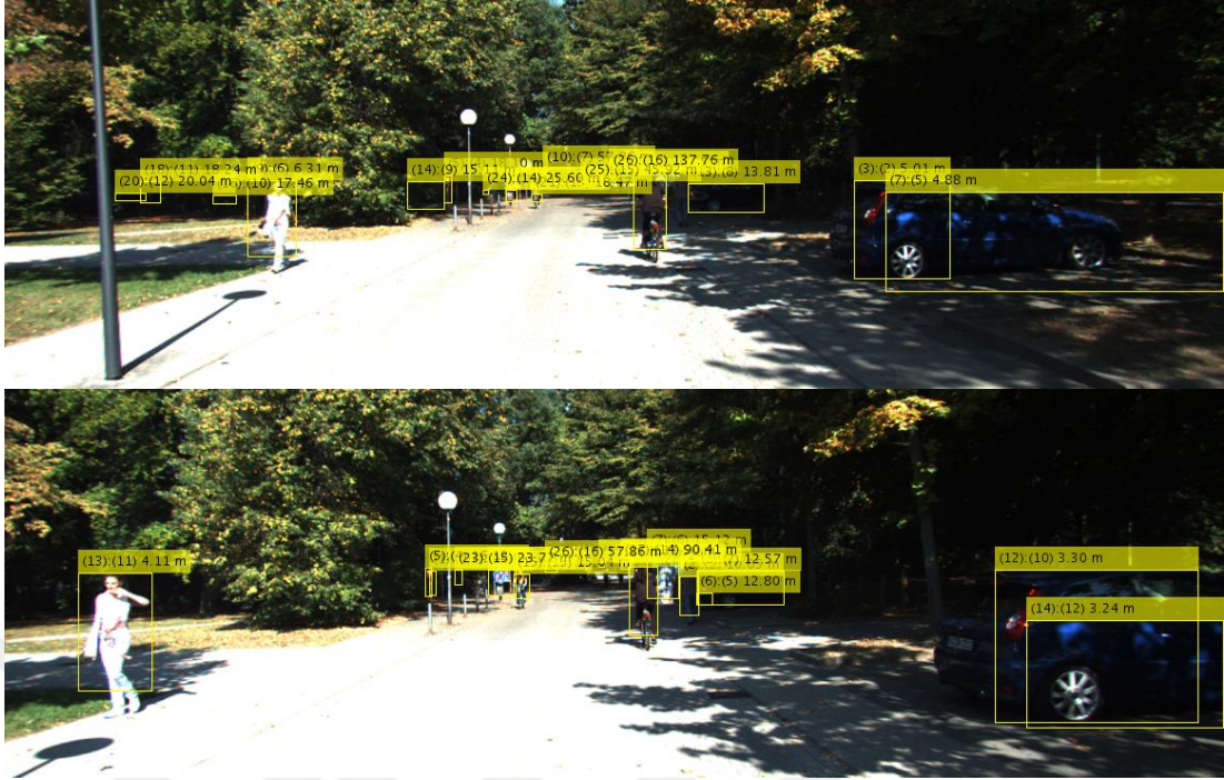
Şekil 4.38. Sistem sonucu elde edilen pozitif yaya sonuç ve uzaklıkları.
