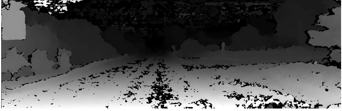
Şekil 4.5. Kenarlık kaldırma algoritmasından sonra elde edilen derinlik haritası.
