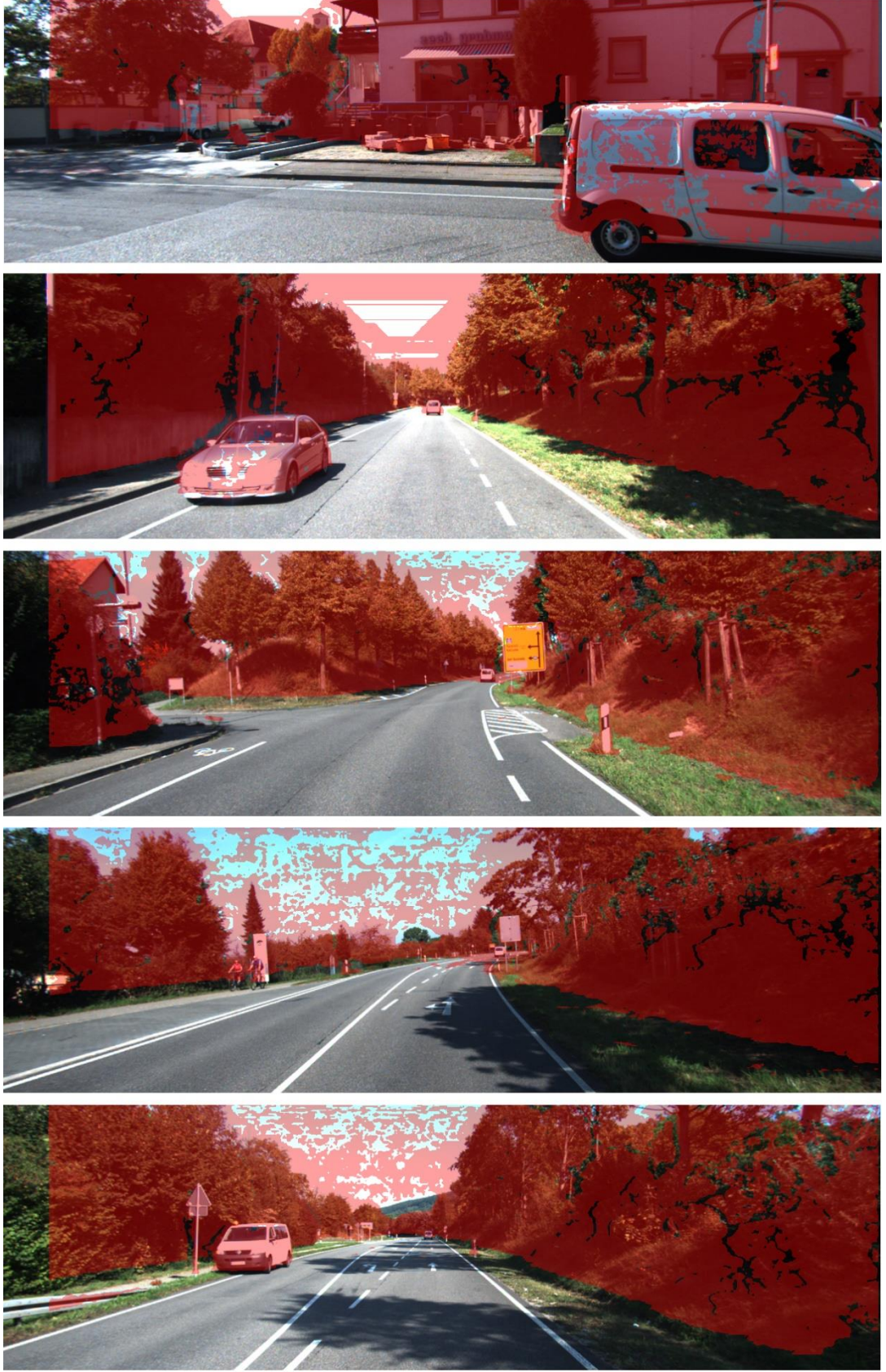
Şekil 3.34.KITTI-2011_09_26_drive_0070 görüntü setindeki sırasıyla 3-72-156-234-414 nolu görüntülerde engel tanıma algoritması test sonuçları.
