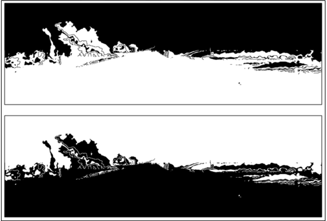
Şekil 3.52. AIR ve yer düzlemi bölgelerinin birleşimi (üst), tersi alınarak elde edilen bölge (alt).
