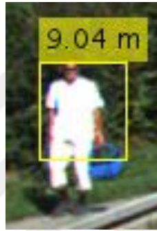
Şekil 3.67. Bulunan yaya üzerinden hesaplanan uzaklık tespiti.
