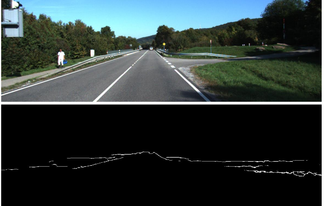
Şekil 3.39. Orijinal test görüntüsü (üst) ile Yer düzlemi ile engelleri ayıran doğru kullanılarak elde edilmiş bölge sınır çizgileri (alt).
