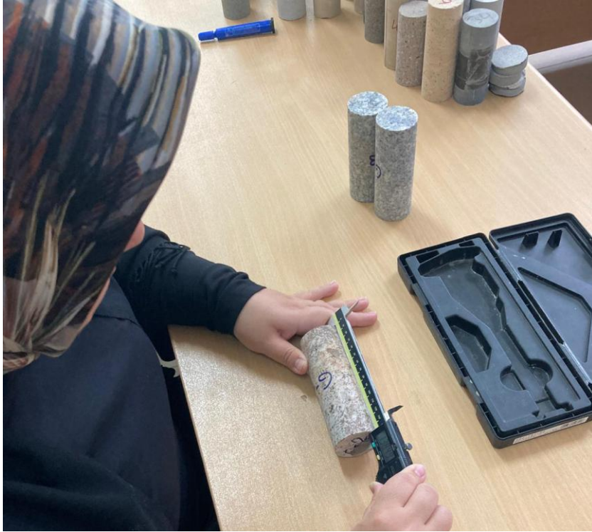
Şekil 5. Karot örneklerinin boyutlarının dijital kumpas ile ölçülmesi
