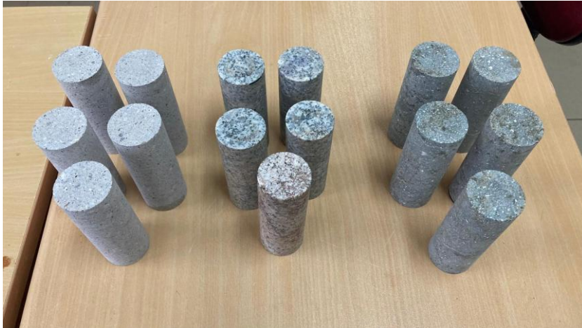
Şekil 3. Tez çalışması kapsamında alınan karot örnekleri
