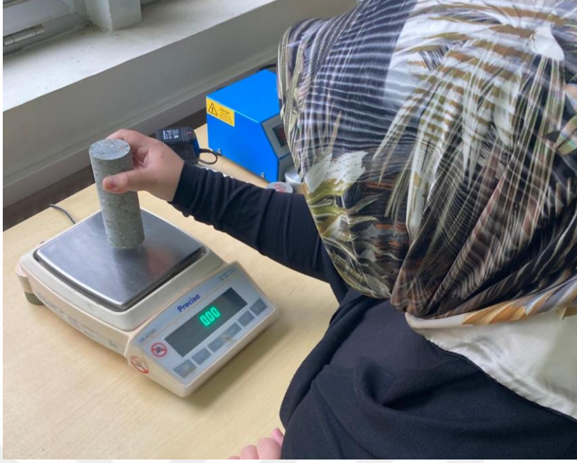
Şekil 6. Karot örneklerinin kuru kütlelerinin belirlenmesi
