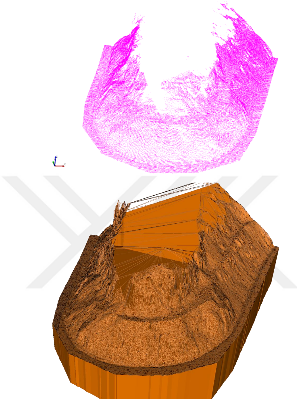
Şekil 37. RocPro3D yazılımında Şev-1 için oluşturulan nokta bulutu (üstte) ve TIN (altta)
