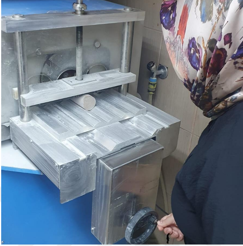
Şekil 4. Karot örneklerinin alt ve üst yüzeylerinin düzeltilmesi
