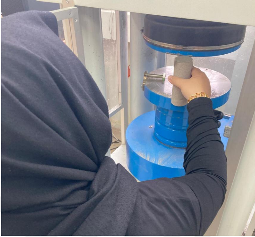
Şekil 7. Tek eksenli sıkışma dayanımı deneylerinin yapılışı
