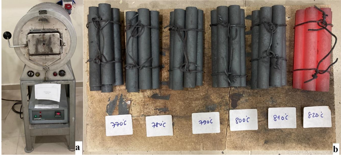
Şekil 3.3. (a) Çalışmalarda kullanılan ısıtma fırını (b) Isıl işlem görmüş numuneler
