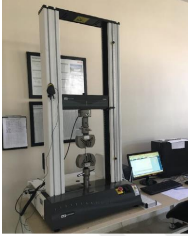
Şekil 3.8. Çekme testlerinde kullanılan Instron 3369 model 50 kN çekme ve basma kapasitesine sahip üniversal test cihazı
