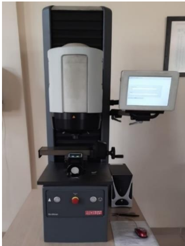
Şekil 3.9. Sertlik ölçümlerinde kullanılan Emcotest DuraVision 200 model sertlik ölçme cihazı
