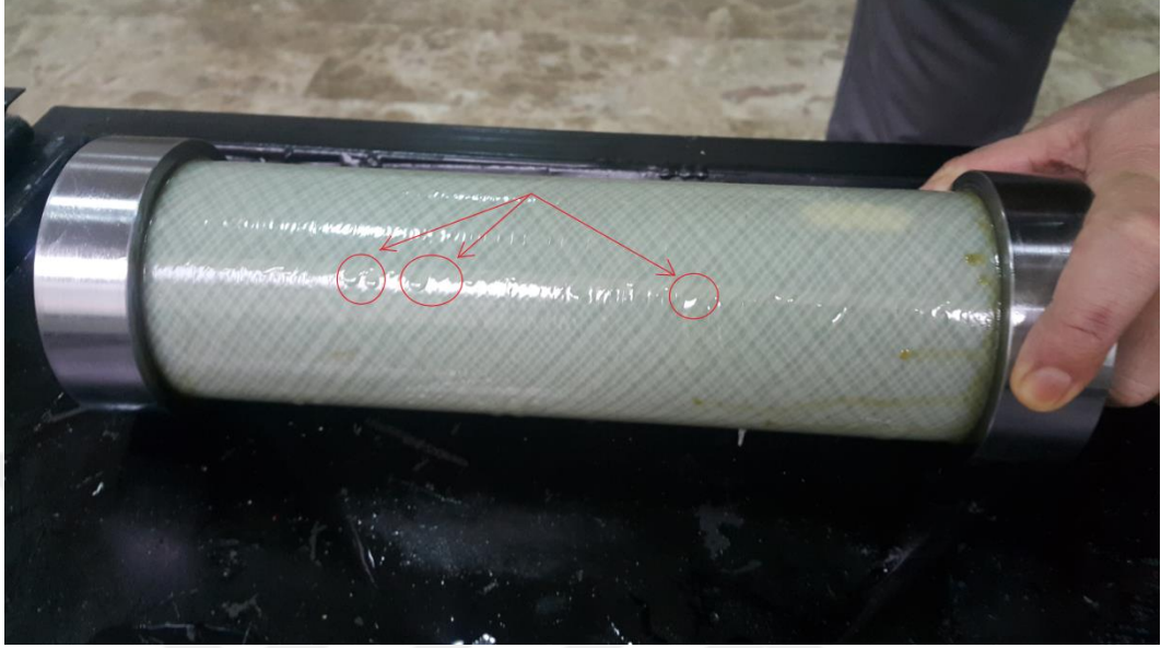
Şekil 4.5. C-C-C-C numunesine ait hasar durumu
