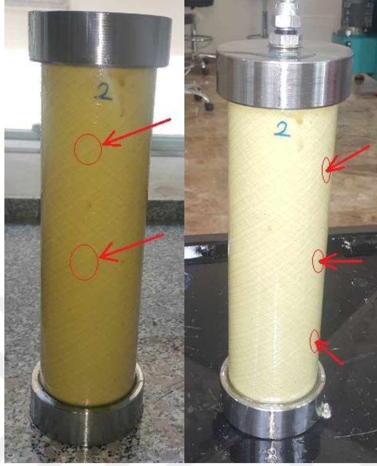
Şekil 4.7. C-A-C-C numunesine ait hasar durumu
