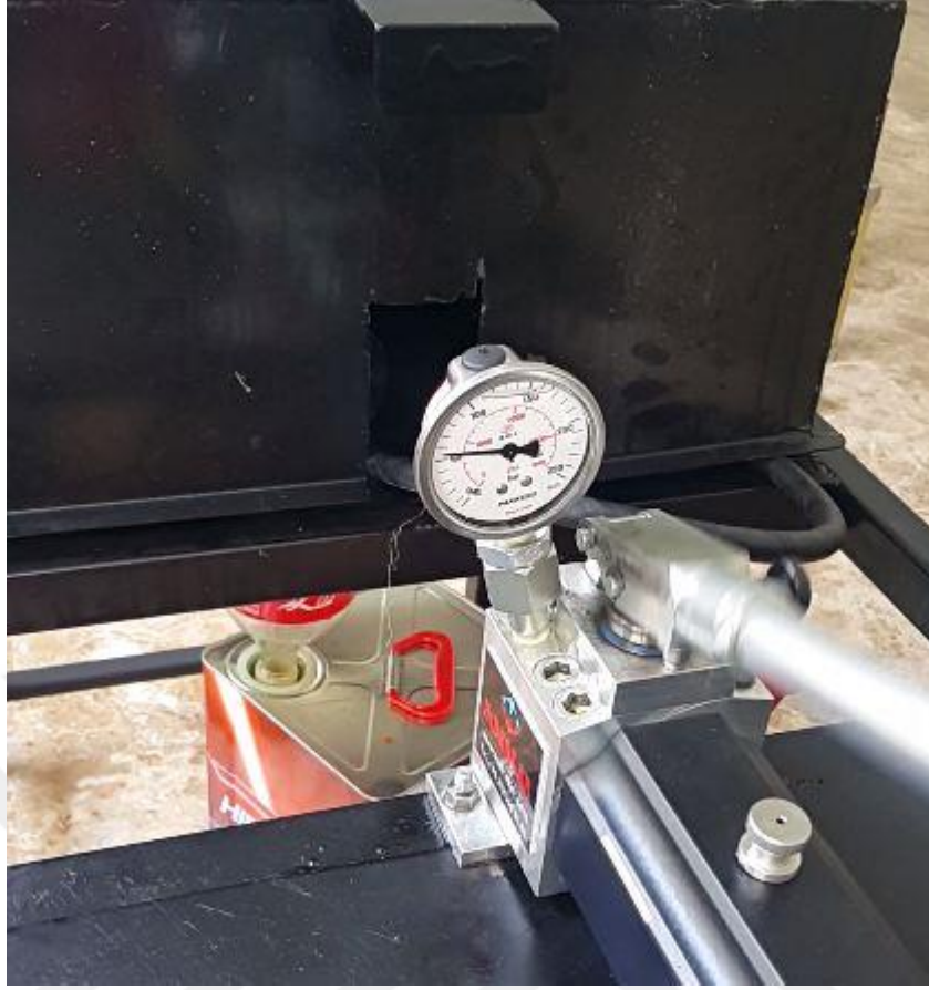
Şekil 4.6. C-A-C-C numunesine ait en yüksek basınç değeri
