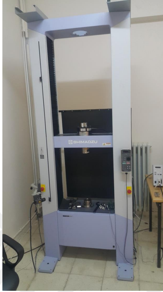
Şekil 3.19. Çekme deneylerinin yapıldığı test cihazı
