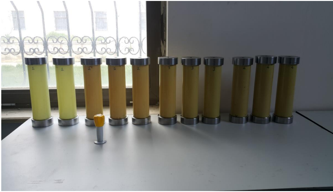
Şekil 4.4. İçsel basınç uygulamaya hazır hale getirilen numuneler
