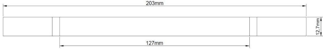
Şekil 3.17. Çekme deneyi için hazırlanan numuneye ait ölçüler
