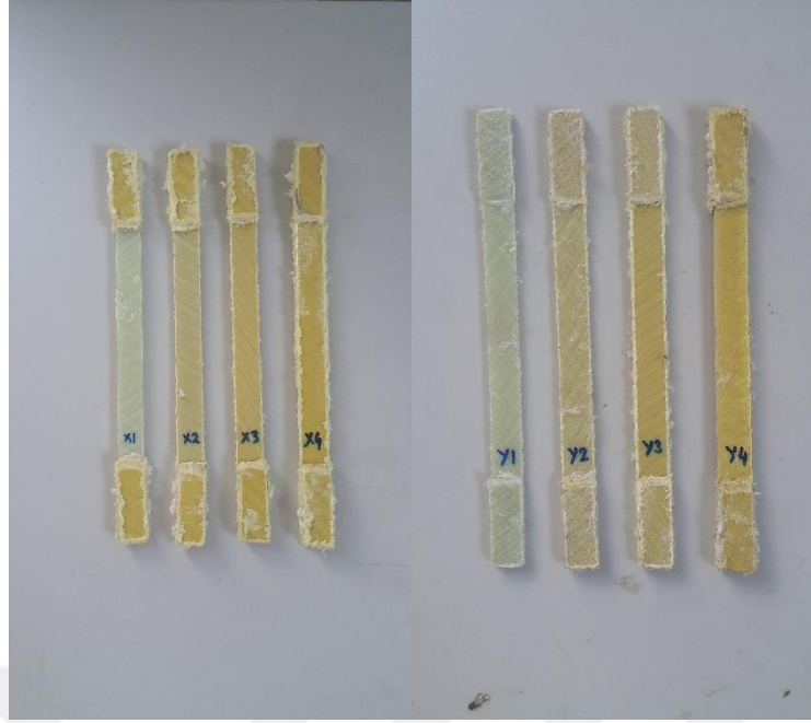
Şekil 3.18. x ve y yönlerinde hazırlanan çekme deneyi numuneleri
