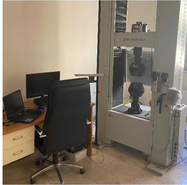
Şekil 3.14. Çekme cihazı ve dataların kaydedildiği bilgisayar
