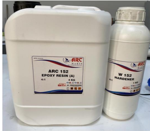
Şekil 3.1. Matris malzemesi olarak kullanılan ARC 152 epoksi reçine ve W152 sertleştirici
