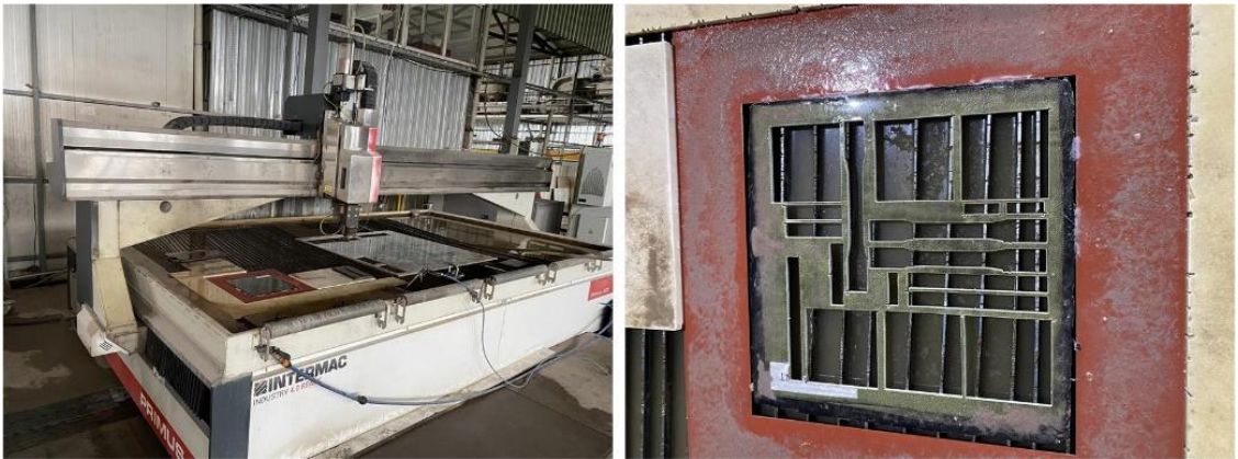
Şekil 3.12. Su jeti yardımıyla numunelerin kesilmesi
