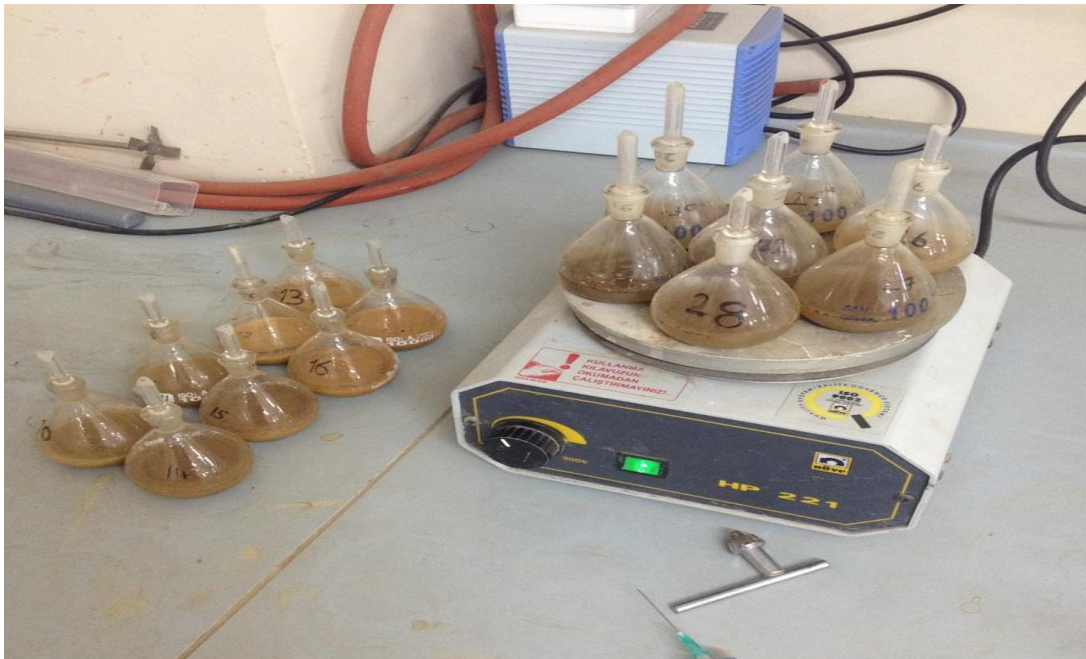
Şekil 16. Piknometre yöntemiyle tane yoğunluğunun belirlenmesi
