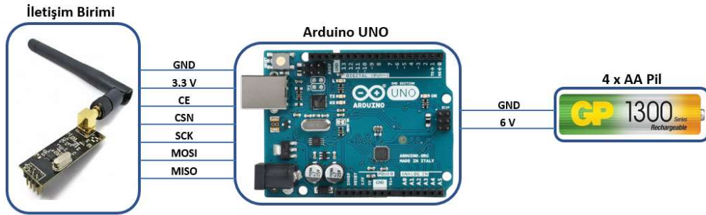
Şekil 3.11. KSA Diğer İstasyonların Yapısı.
