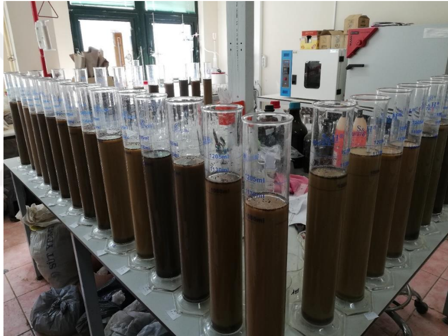
Şekil 13. Tekstür Analizi (Bouyoucos'un hidrometre yöntemine göre)
