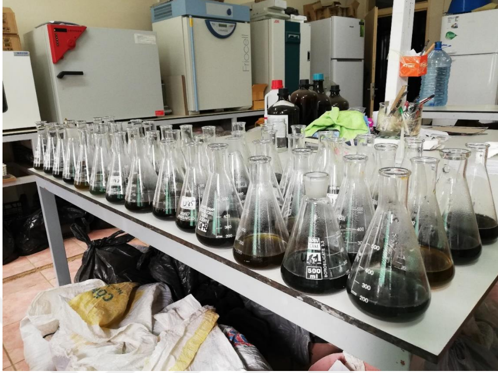
Şekil 15. Organik madde belirlemek için titre edilen toprak örnekleri.
