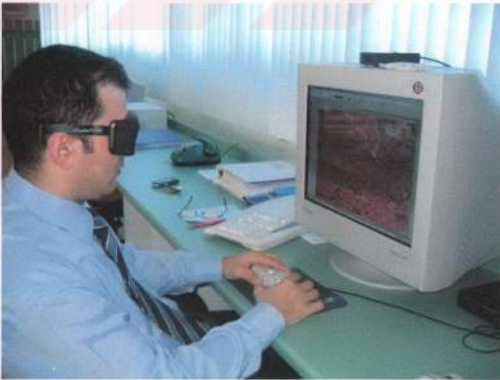
Şekil 26. Digital fotogrametrik sistem ve değerlendirme çalışması
