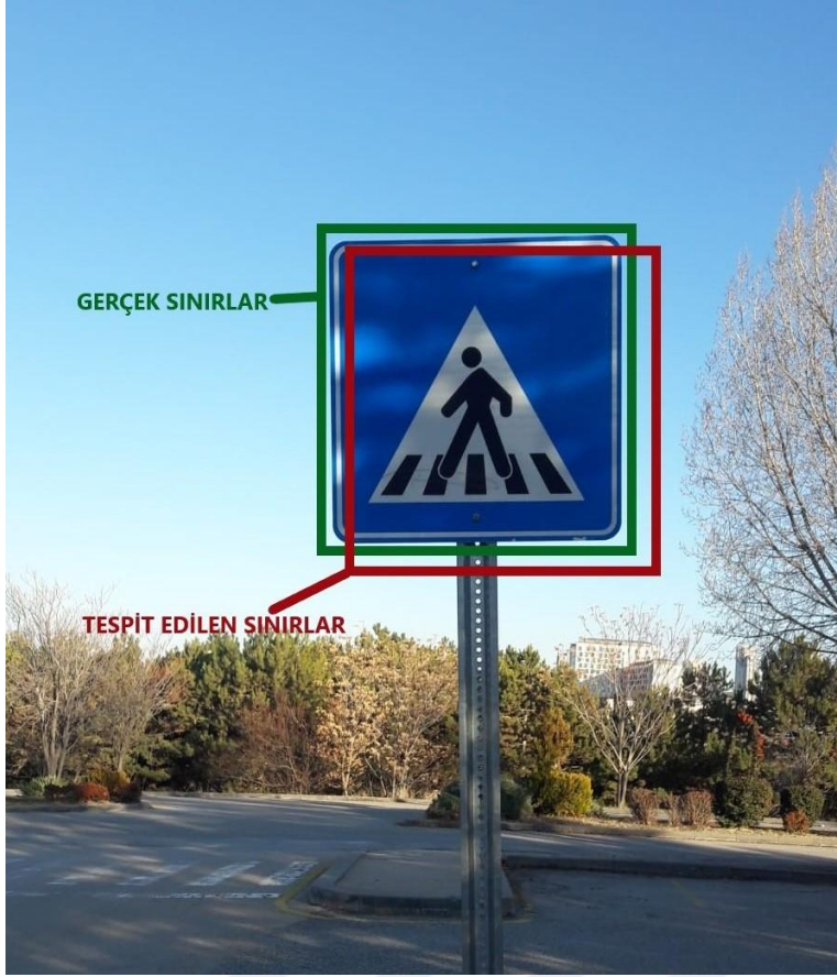
Resim 3.2. Trafik işaretinin yeşil çerçeve ile gerçek sınırları, kırmızı çerçeve ile nesne tespit algoritmasından elde edilen sınırları gösterilmiştir
