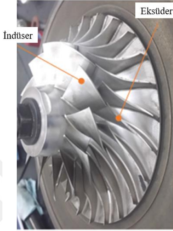
Şekil 3.19: Tipik ardışık kanatlı çark yapısı [44].
