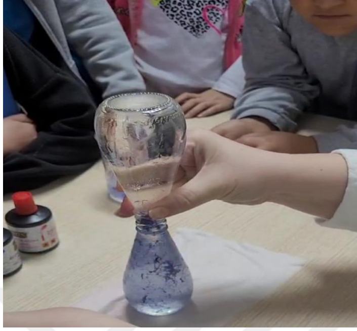
Resim 3.4 Öğrencilerle yapılan “Sıcak soğuğu çeker mi?” adlı deneyden, sıcaklıkları aynı olan maddelerin arasında ısı alışverişi olmadığını gösteren deney görüntüsü
