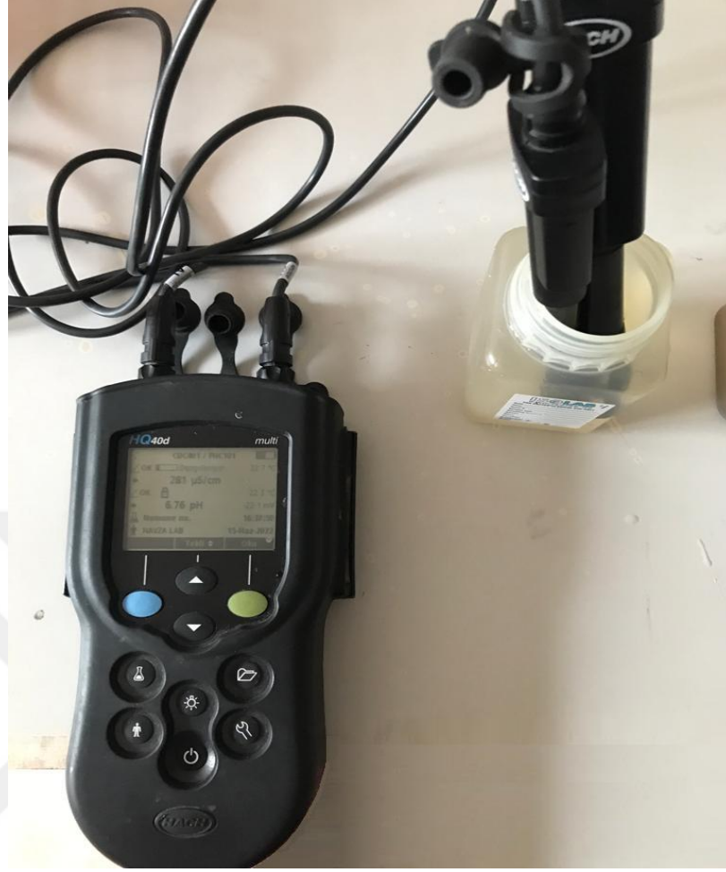
Şekil 31. pH ve EC Miktarını Belirleme
