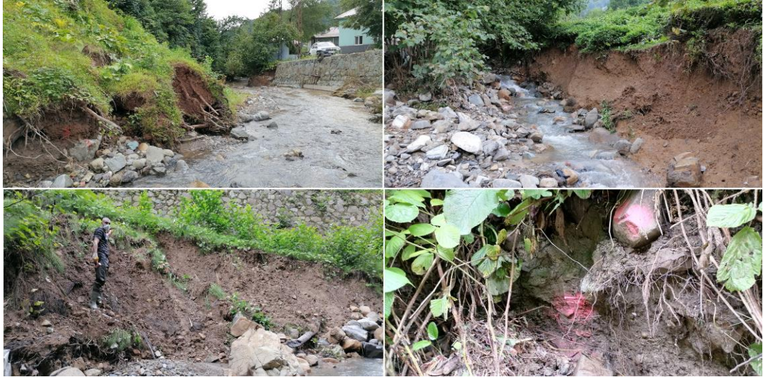
Şekil 36. Erozyon Çubuk Yöntemi Uygulanan Alanlar ve Erozyon
