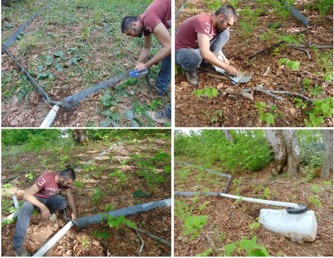
Şekil 19. Yüzeysel Akış Parselleri Kurulumu
