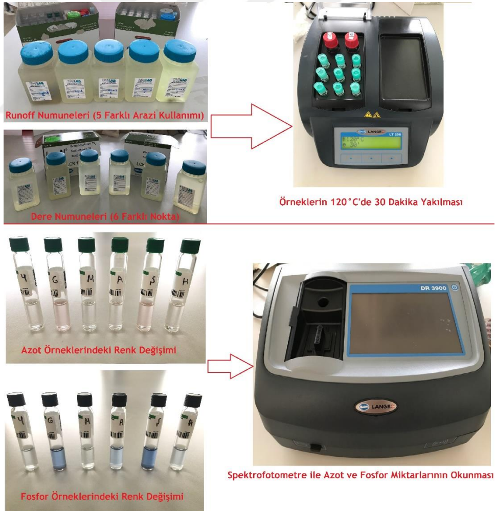
Şekil 30. Azot ve Fosfor Belirleme Aşamaları
