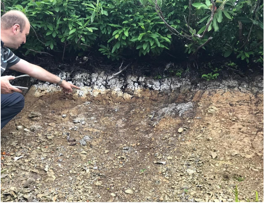
Şekil 10. Yüksek Yağışlar Neticesinde Yıkanmış Bir Toprak Üst Katmanı
