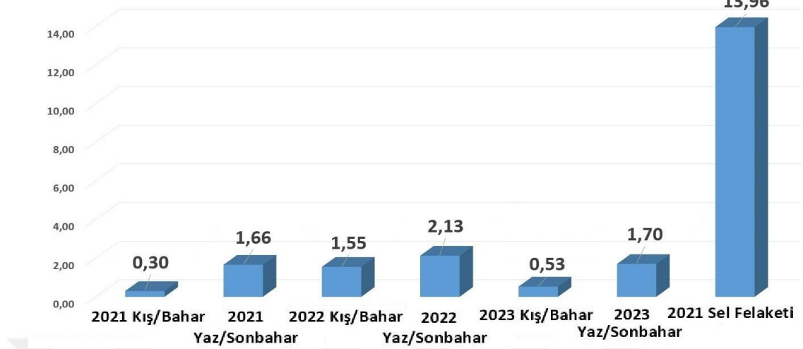
Şekil 34. 2021-2023 Yılları Arası Kanal ve Oyuntu Deresi Şevlerinde İlgili Ölçüm Periyotlarında Gerçekleştirilen Erozyon (cm) Miktarları
