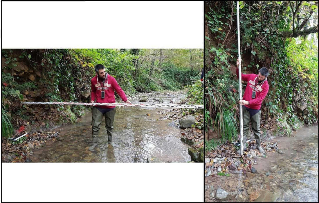
Şekil 18. Deneme Alanlarında Dere Şev Alanlarını Hesaplama
