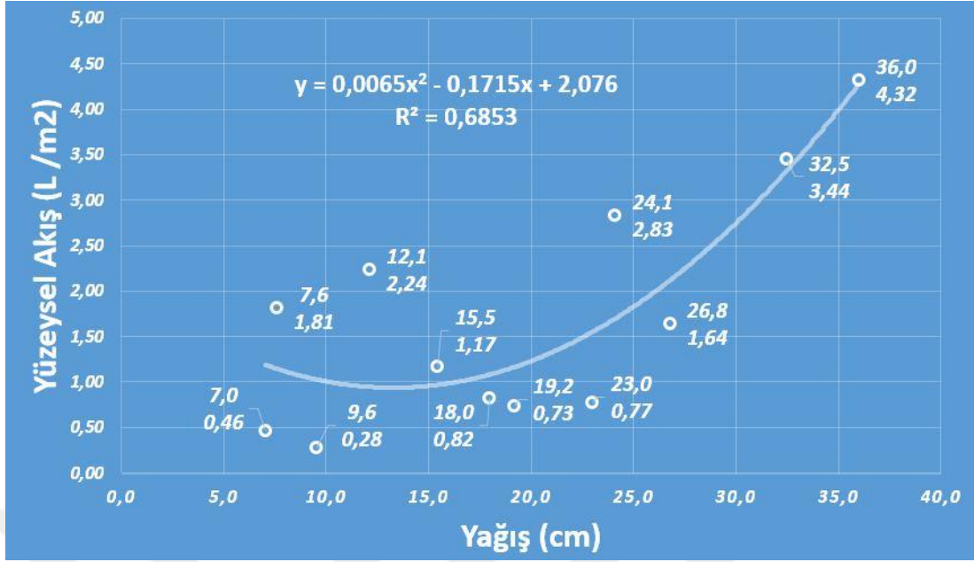
Şekil 42. Yüzeysel Akış Parsellerinde Aylık Akışlar ve Yağış Miktarı İlişkisi
