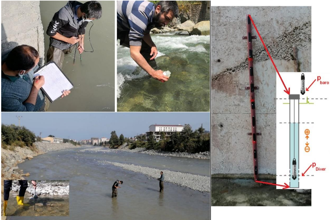
Şekil 29. Debi Ölçümü, Su Örneği Alımı ve Diver Cihazı Görünümü
