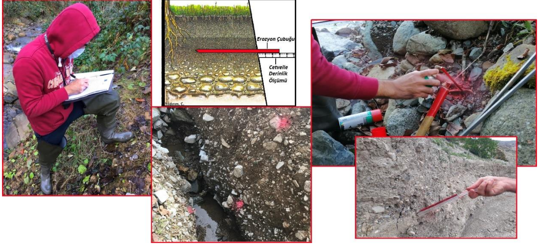
Şekil 16. Erozyon Çubukları Ölçümleri
