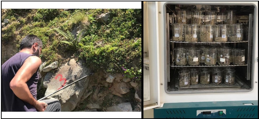
Şekil 17. Deneme Alanlarından Yapılan Hacim Örnekleme ve Fırınlanması
