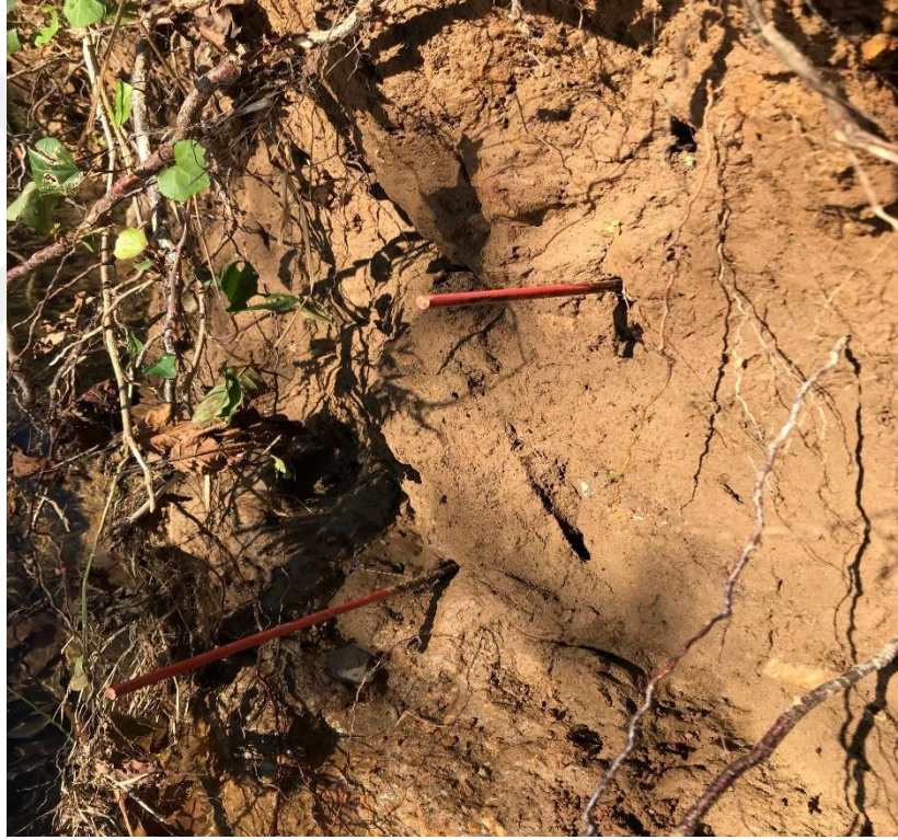
Şekil 14. Dere Kenarına Uygulanmış Erozyon Çubukları
