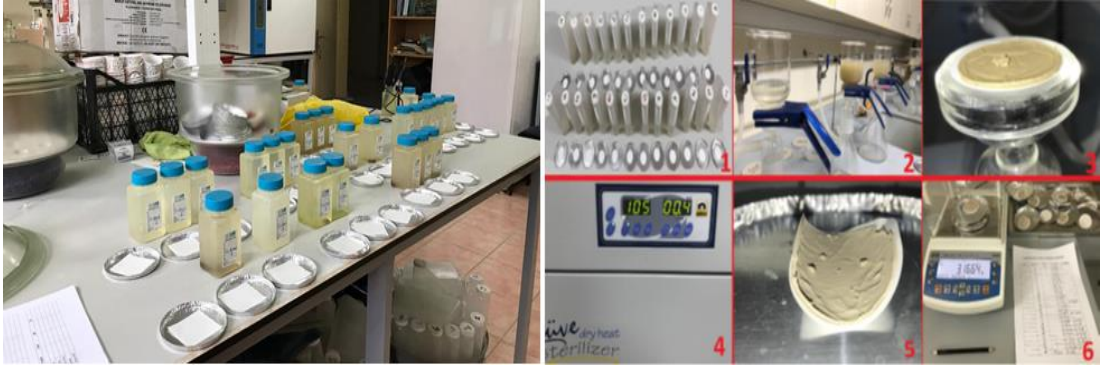
Şekil 23. Askıda Katı Madde (Sediment) Belirleme Aşamaları
