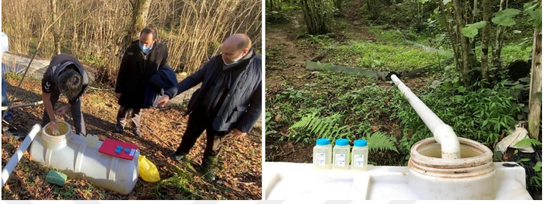
Şekil 22. Yüzeysel Akış Parsellerinden 3 Adet Örnek Alımı
