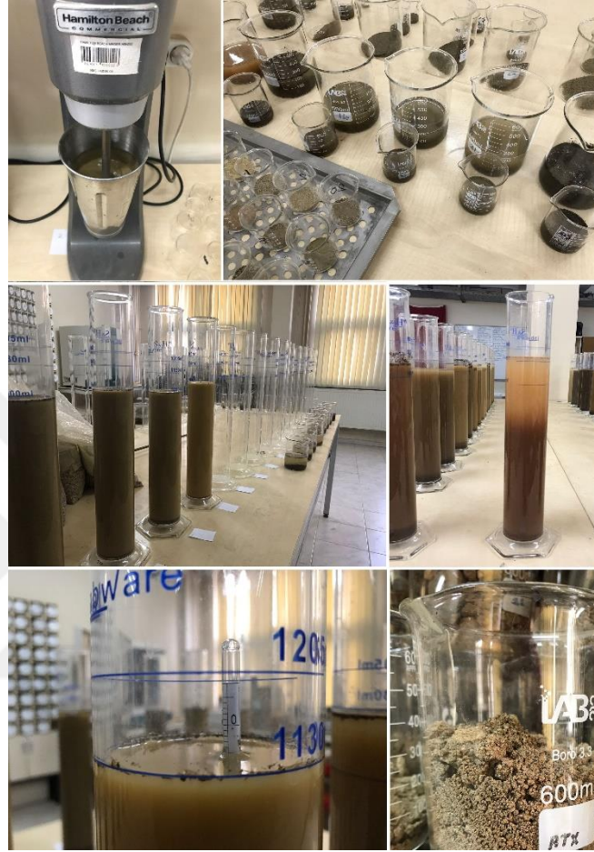
Şekil 25. Bouyoucos'un Hidrometre Yöntemi Aşamaları
