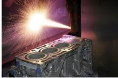
Şekil 2.14. Motor silindir blok içlerinin aşınmaya karşı elektrik ark sprey kullanılarak kaplanması [28].
