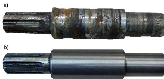
Şekil 2.13. a) İş parçası yüzeyinde kullanım esnasında ortaya çıkan aşınma b) İş parçası yüzeyindeki aşınmanın elektrik ark sprej kullanılarak tamir edilmiş hali [26].
