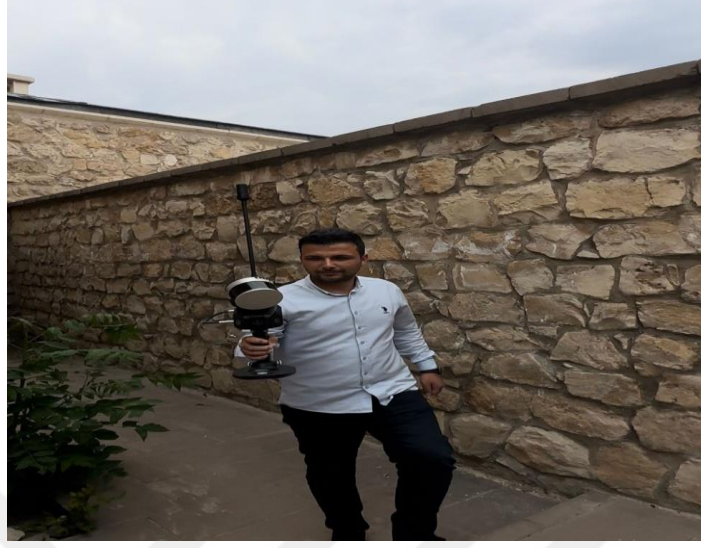
Şekil 3.30. STONEX X120GO slam el tipi lazer tarayıcı ile ölçüm işlemi.
