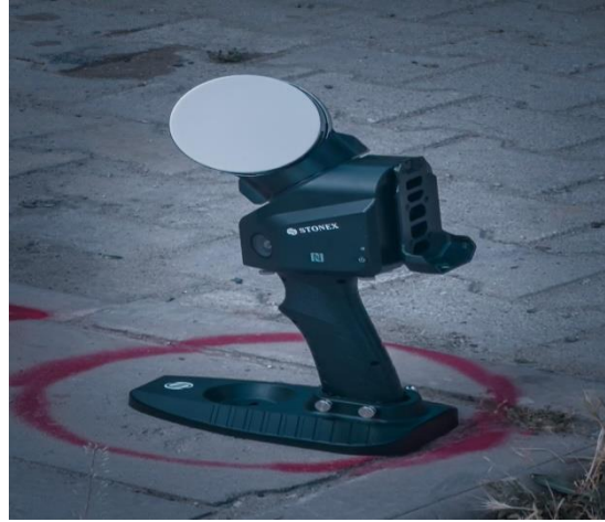
Şekil 3.31. STONEX X120GO slam el tipi lazer tarayıcı ile YKN ölçümü.
