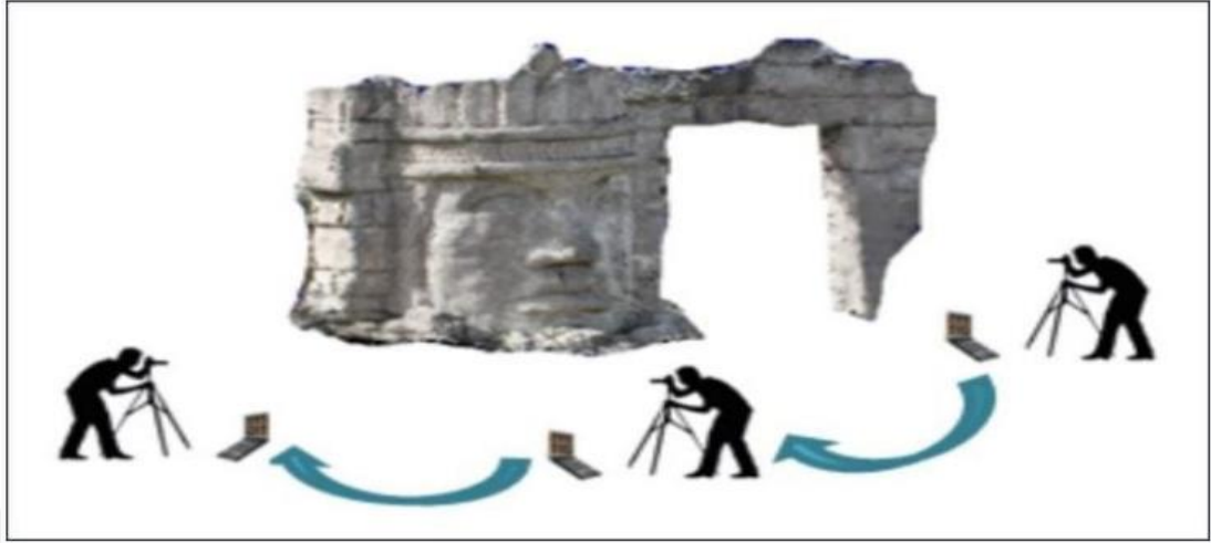
Şekil 2.1. Yersel fotogrametri iş akışı (URL-1).
