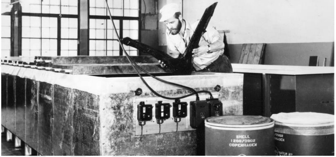
Şekil 2. 47: Isıtma fonksiyonlu PEG tankında daldırma işlemi.
