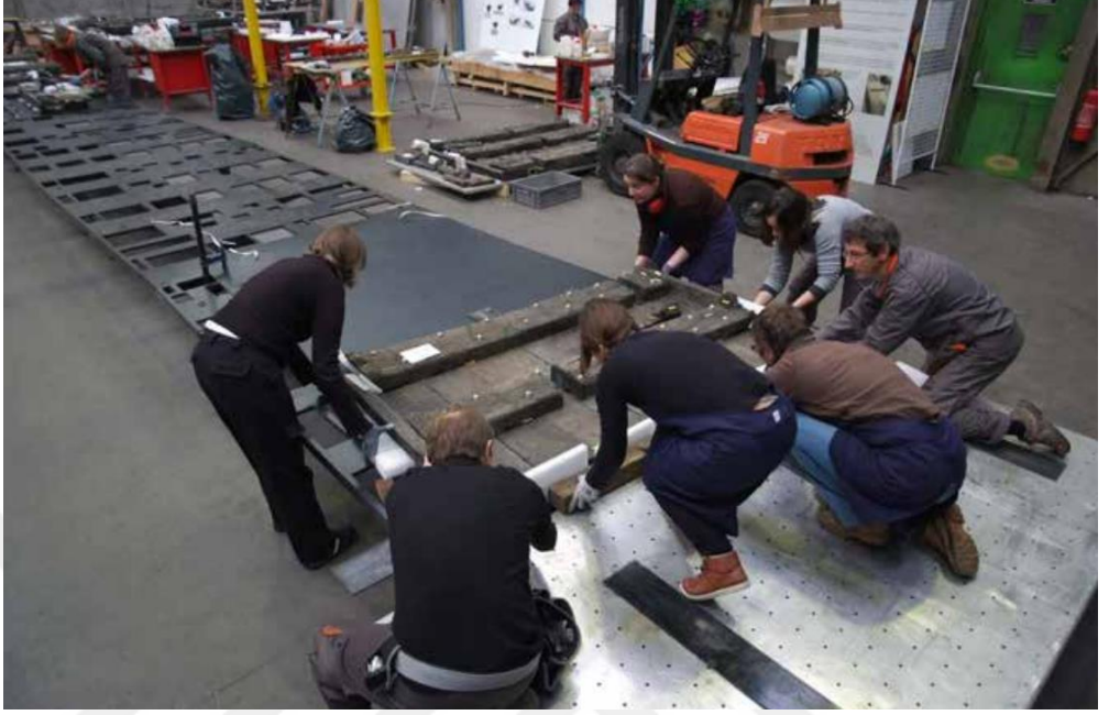
Şekil 2. 76: G vde ahşaplarının taşıyıcı konstr ksiyon  zerinde yeniden montaj  alıřmaları.
