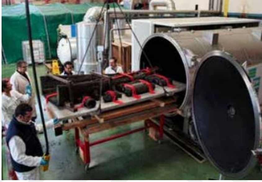
Şekil 2. 73: Gövde ahşaplarının dondurarak kurutma aşaması.
