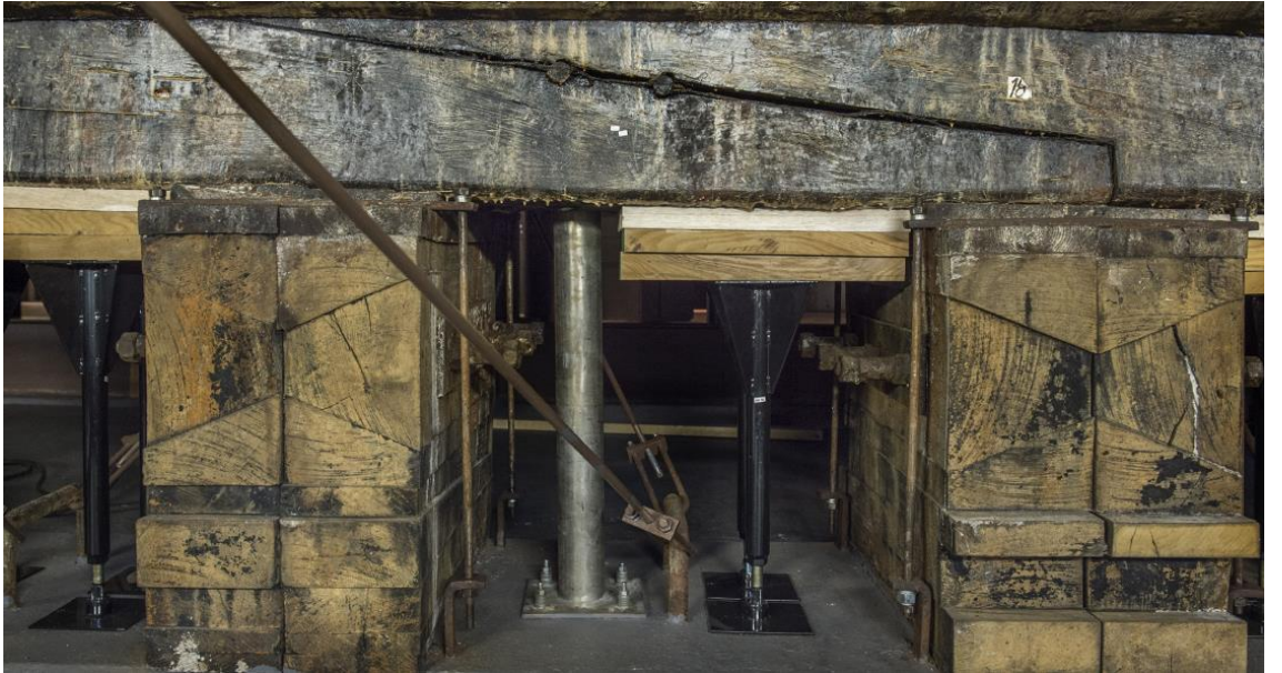
Şekil 2. 25: Omurganın alt kısmında artırılan ayarlanabilir destekler.
