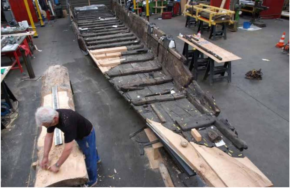
Şekil 2. 75: Gövdenin eksik kısımlarının tümlenme işlemi.
