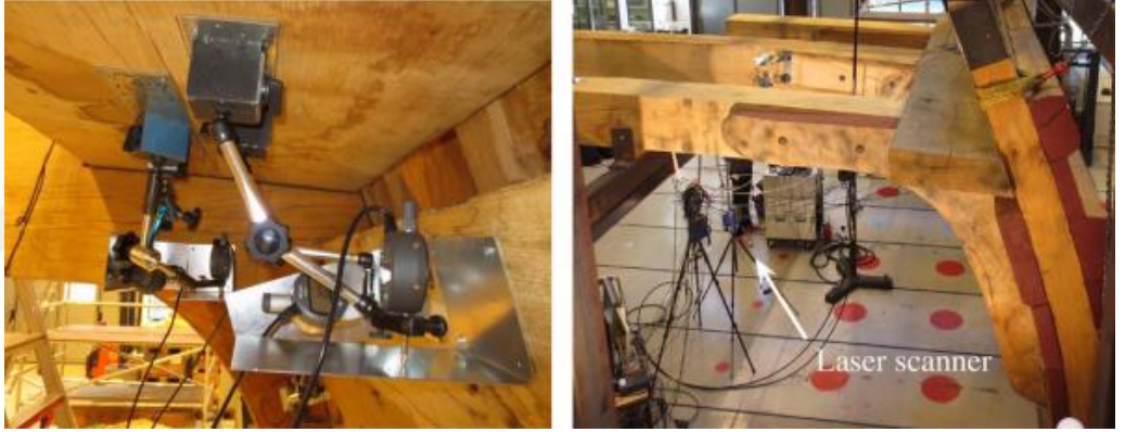
Şekil 2. 19: Selescos p-1-25 cihazı ile yer değiştirme ölçümü.
