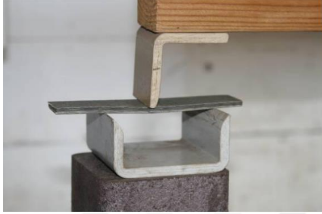
Şekil 2. 96: Seçilen örnek üzerinde yapılan kırılma gerinimi testi.
