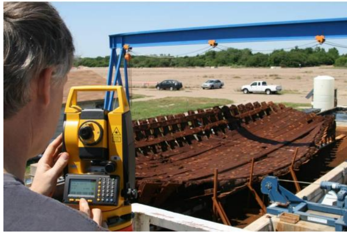
Şekil 2. 99: Total Station cihazı ile ahşapların belgelenmesi.
