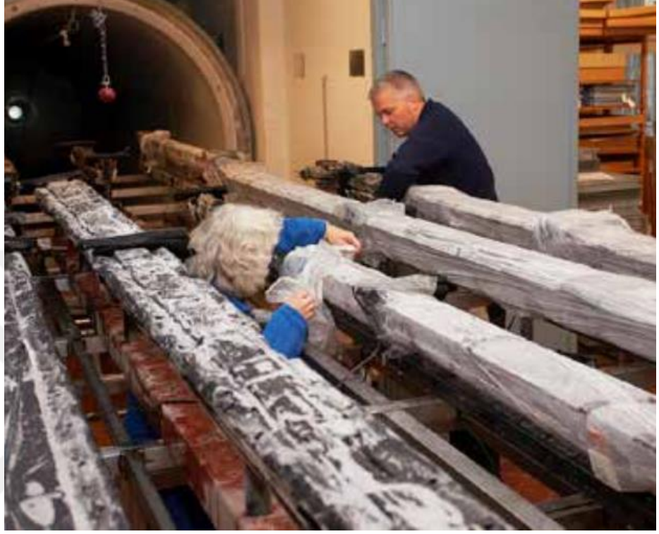
Şekil 2. 52: Roskilde 6 Batığı'nın omurgasının dondurarak kurutma cihazına yerleştirilmesi.
