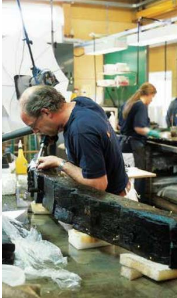
Şekil 2. 51: Batık ahşaplarının Faro Arm cihazı ile 3 boyutlu belgelenmesi.
