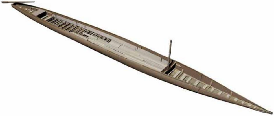
Şekil 2. 72: 3 boyutlu belgeleme çalışmaları baz alınarak oluşturulan gövde modeli.
