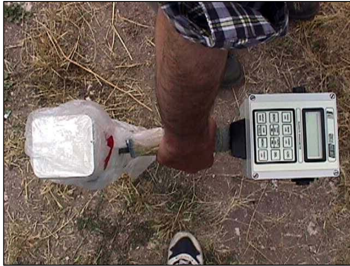
Şekil 2.11. Amorium antik kentinde kullanılan gradiometreden bir görünüm (Yiğit, 2005)
