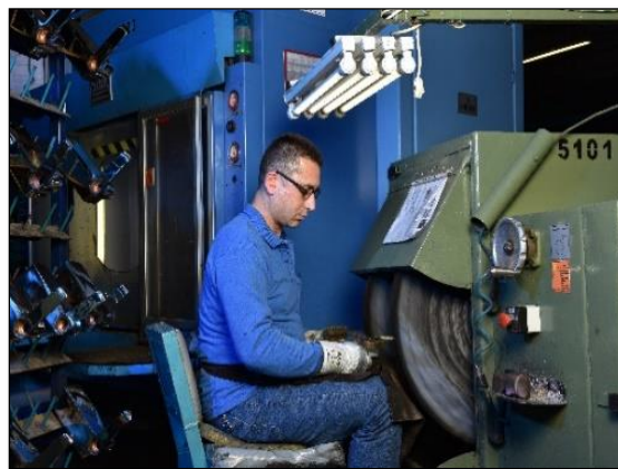
Şekil 17. Endüstriyel zımpara-polisaj operasyonu
