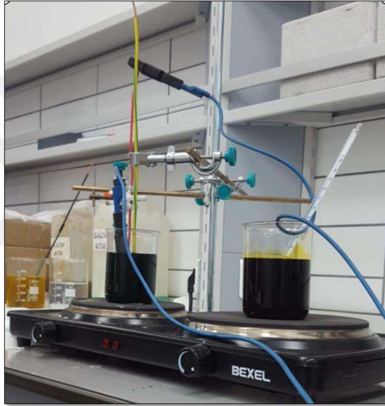
Şekil 18. Nikel ve krom kaplama deney düzeneği
