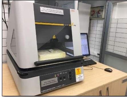
Şekil 20. X-ray kaplama kalınlığı ölçüm cihazı
