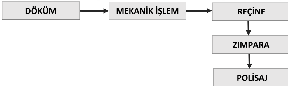
Şekil 16. Katot elektrotu hazırlık işlemleri
