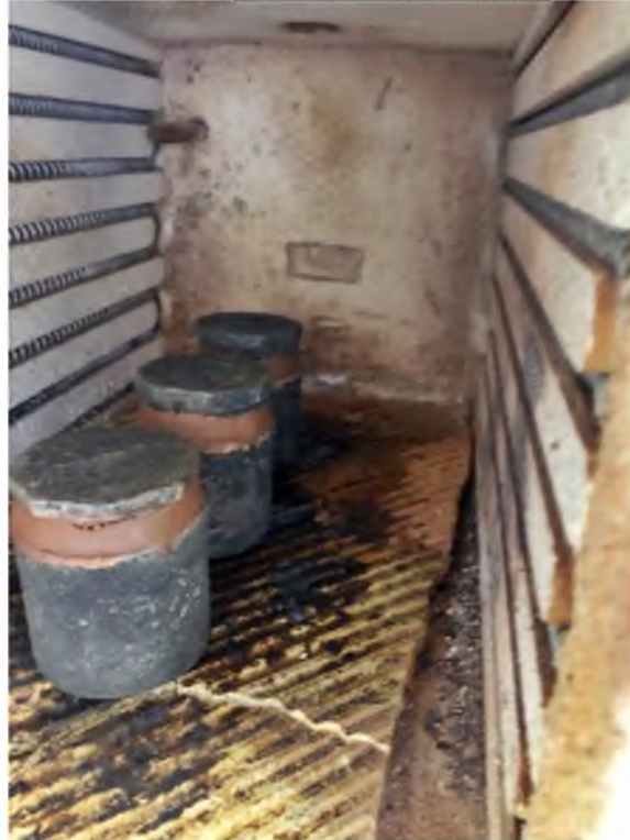
Şekil 4.6. Potaların fırın içerisinden görüntüsü
