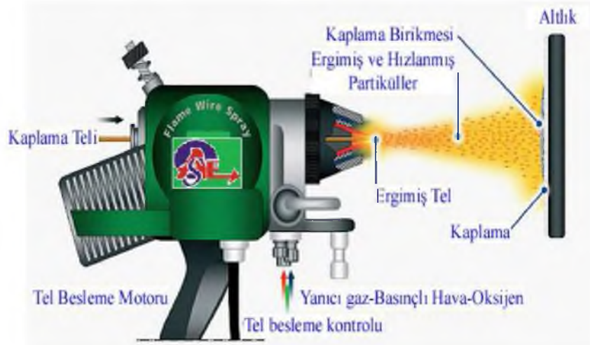
Şekil 3.9. Alev ile püskürtme tekniği (İnternet, Alloy Spray Engineering ,2020)
