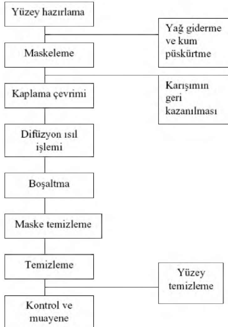
Şekil 3.8. TRD işlem aşamaları (Sinoplu, 2012).
