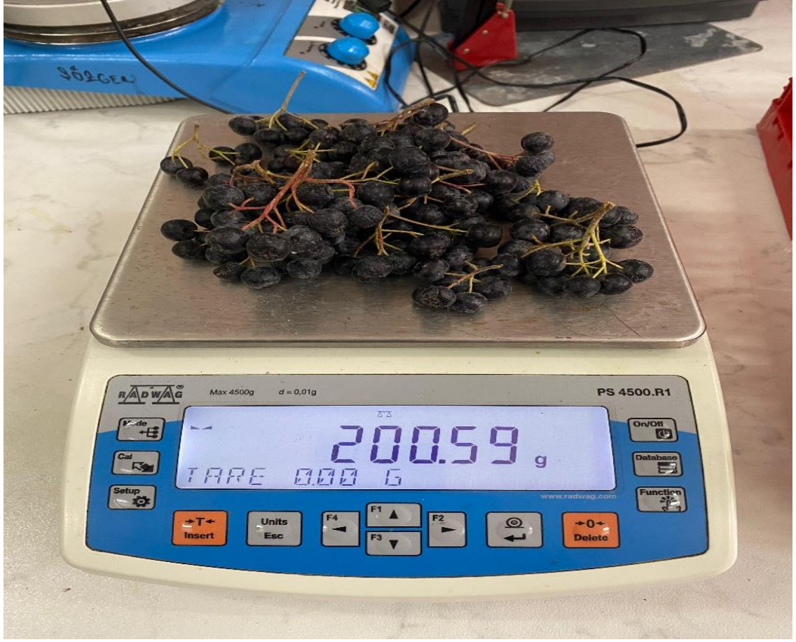
Şekil 3.3.1. 1. Hassas terazi ile ağırlık kaybı ölçümü
