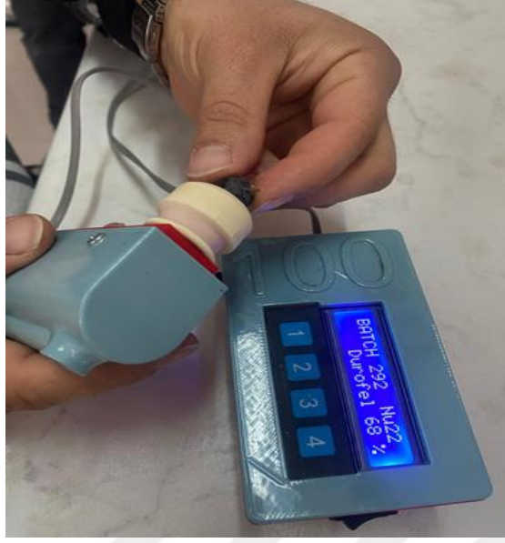
Şekil 3.3.5. 1. Dijital sertlik test cihazı ile örnek ölçümü
