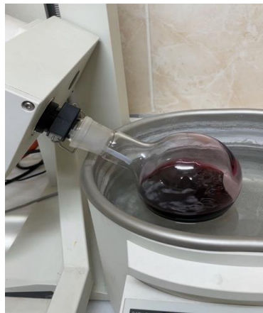
Görsel 3.2. Rotavaporda çözücülerini uçurma işlemi
