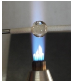
Şekil 8.5. Şalomada çelik mandrele sarılıp şekil verilmiş cam
