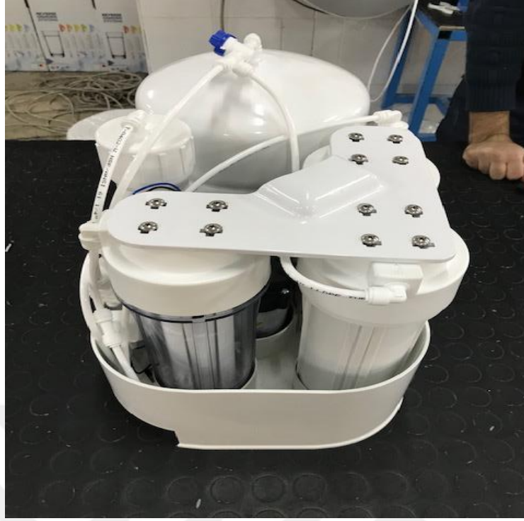
Şekil 14. Alt Parçaların Ara Bağlantılarının Yapılması
