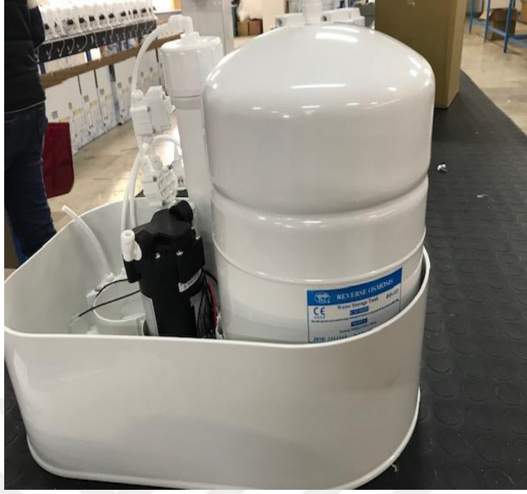
Şekil 12. Metal Tank ve R.O Pompa
