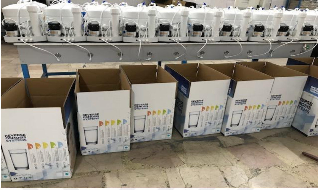
Şekil 16. Su Arıtma Cihazlarının Üretim ve Montajdan Sonra Test Edilmesi
