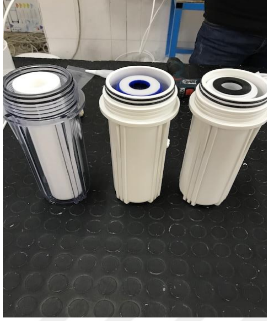
Şekil 10. Membran Dış Kabı
