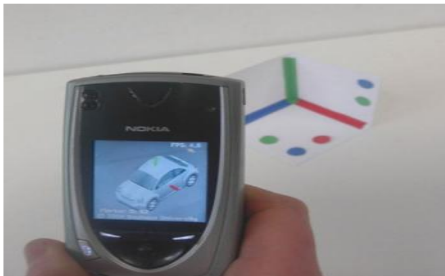
Şekil 2. 17 . 3B işaretçi ve optik takip süreci (Mohring vd., 2004)
