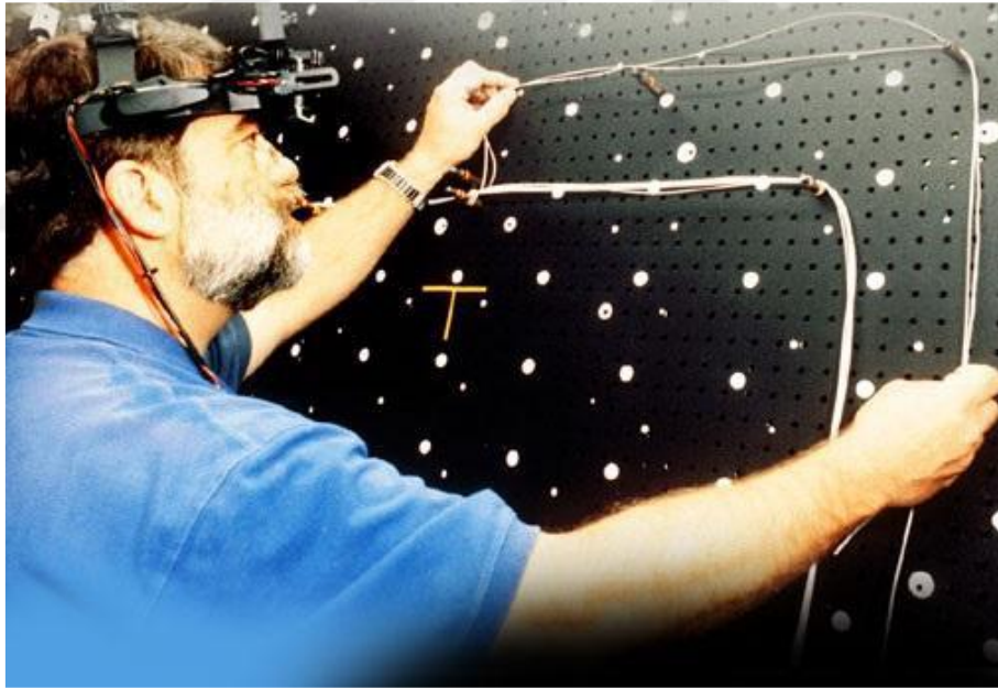
Şekil 2. 7 . Boeing'deki operatörler için geliştirilmiş AG sistemi (Akdağ, 2017).
