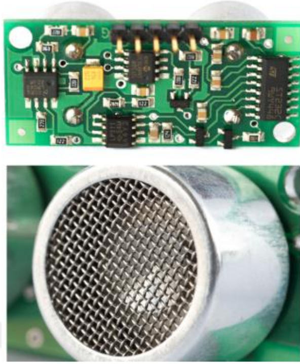
Şekil 10. Akustik İzleme Yapmak İçin Ultrasonik Sensörün Ön Ve Arka Yüzü
