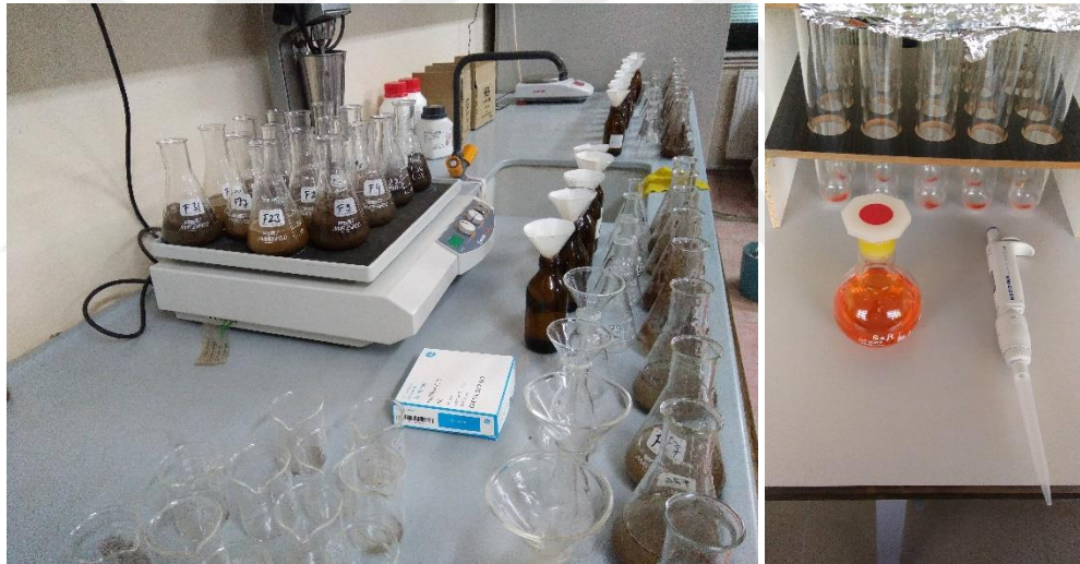
Şekil 25. Mikrobiyal karbon analizi için ekstrakt eldesi ve ekstraktların yakma için tüplere koyulması
