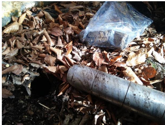
Şekil 23. Çelik silindir ile alınmış ve poşetlenmiş toprak örneği
