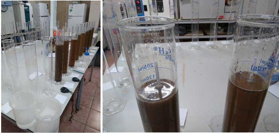
Şekil 24. Toprak tekstürünün belirlenmesinde kullanılan hidrometre silindirleri ve analiz işlemi.
