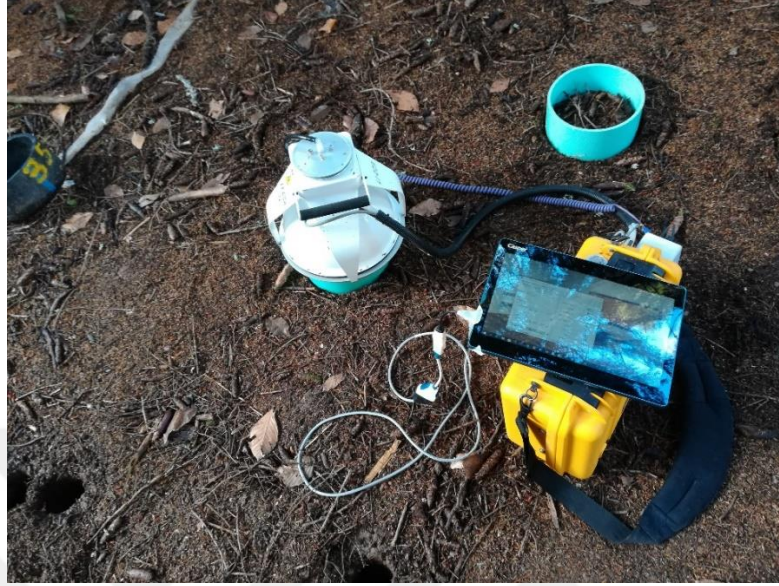
Şekil 22. Arazide Li-Cor 8100A cihazı ile solunum ölçümü
