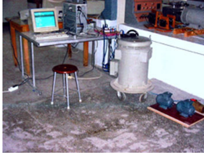
Şekil 5.20. Arıza teşhisi için kurulan deney düzeneği.
