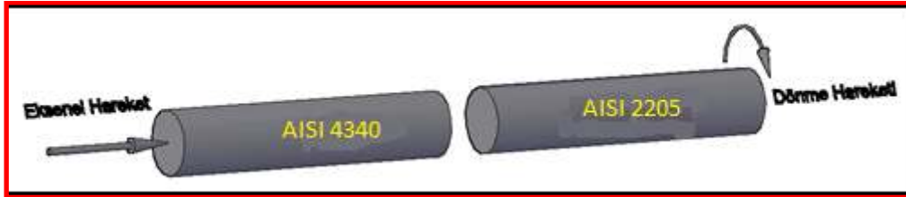
Şekil 7.3. Malzeme çiftinin birleşme düzenini gösteren resim[83]
