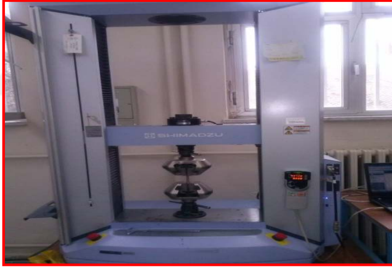
Şekil 7.10. Çekme deney cihazı[82].
