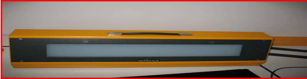
Şekil 8.26. Film inceleme cihazı (Görüntüleyici)[84].
