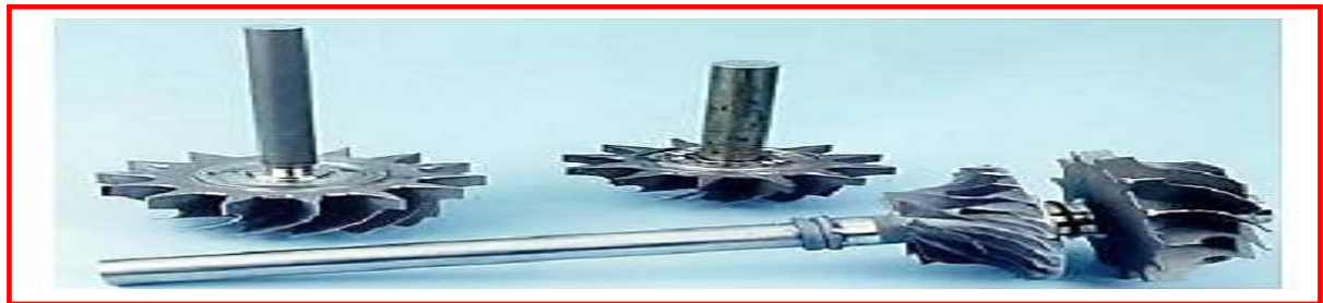
Şekil 5.20. Sürtünme Kaynağı ile imal edilmiş uçak parçası[71].
