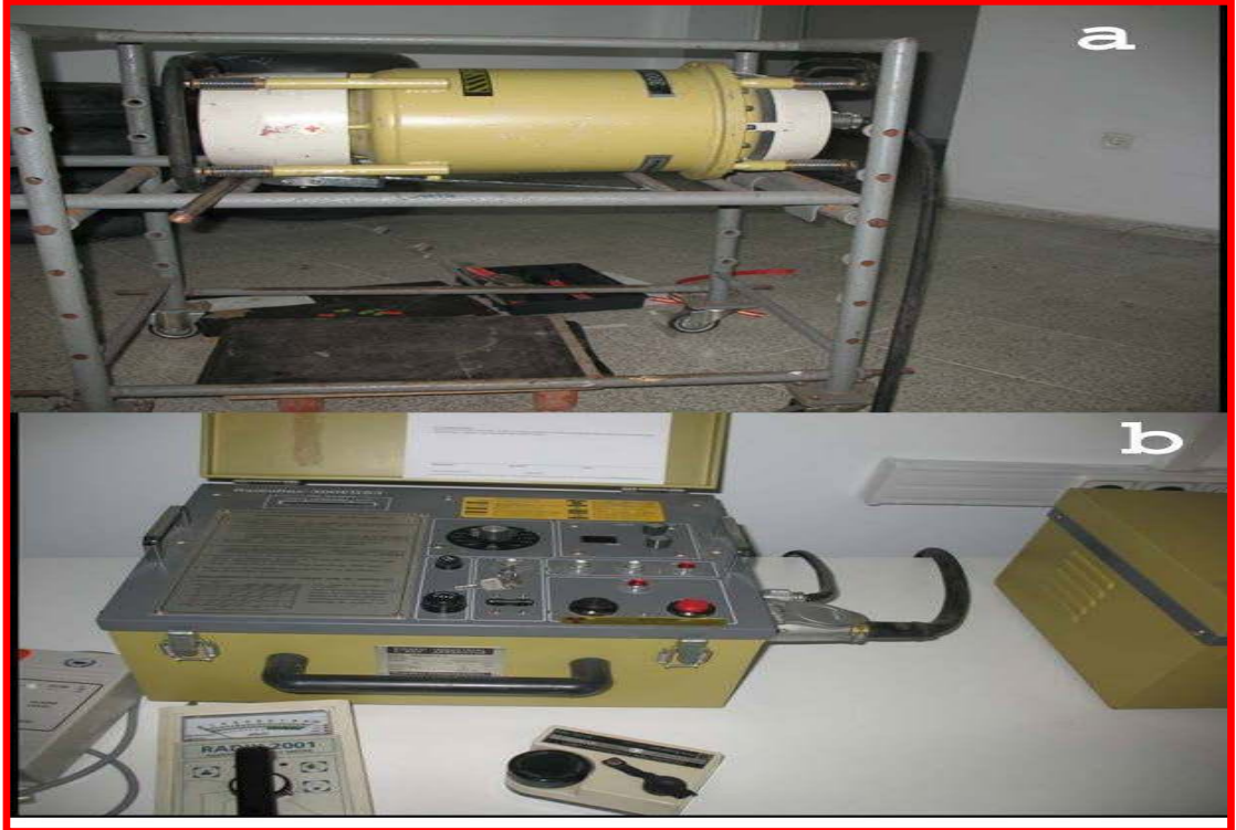
Şekil 7.13.Rigaku marka Radioflex -300EGS3 tipi cihaz (a) ve control paneli (b)[84].
