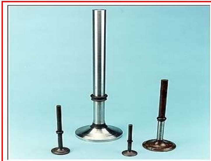
Şekil 5.17.Sürtünme kaynağı ile imal edilmiş egzoz supapları [71,80]
