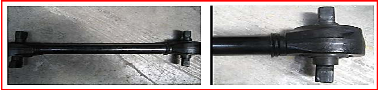
Şekil 5.19. Ticari araçlarda sürtünme kaynağı uygulanmış çeki kolları [71].
