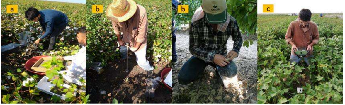
Şekil 3.6. Toprak örneklerinin alınması ve arazi ölçümlerinin yapılması (a: Bozulmuş örneklerin alınması, b: bozulmamış örneklerin alınması, c: penetrasyon ölçümü)
