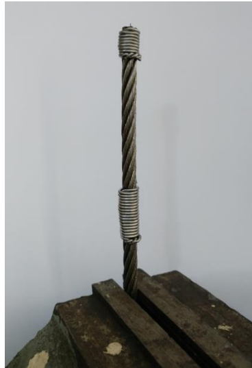
Şekil 5.5 Tellerine ayırma işlemine hazır numune
