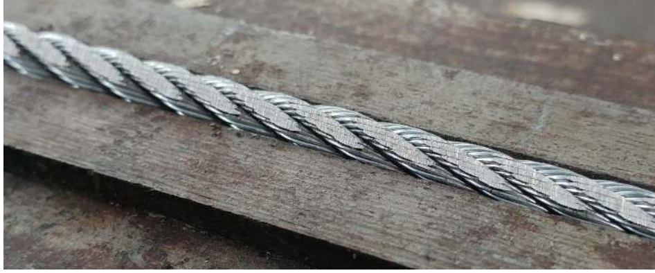
Şekil 5.13 Aşınmış halat numunesi
