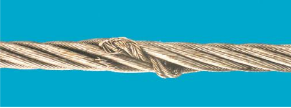
Şekil 4.8 Öz veya damarın dışarı çıkması [14]
