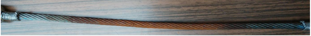
Şekil 5.15 Korozyona uğramış halat numunesi
