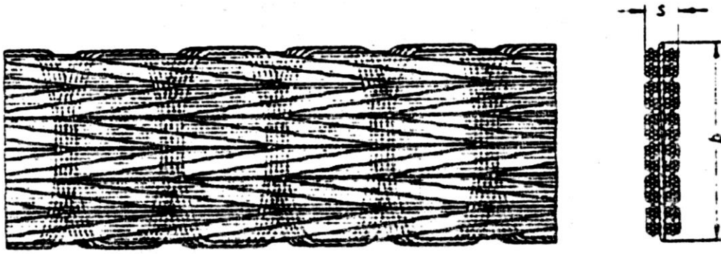
Şekil 2.13 Çift dikişli yassı halat, DIN 21256
