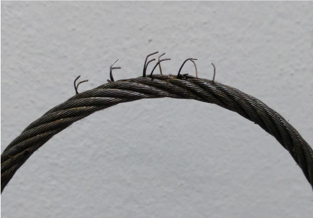
Şekil 5.12 Tel kırıkları verilmiş halat numunesi
