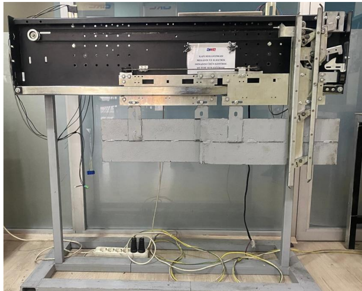
Şekil 3.1 Asansör kapı test mekanizması bileşenleri
