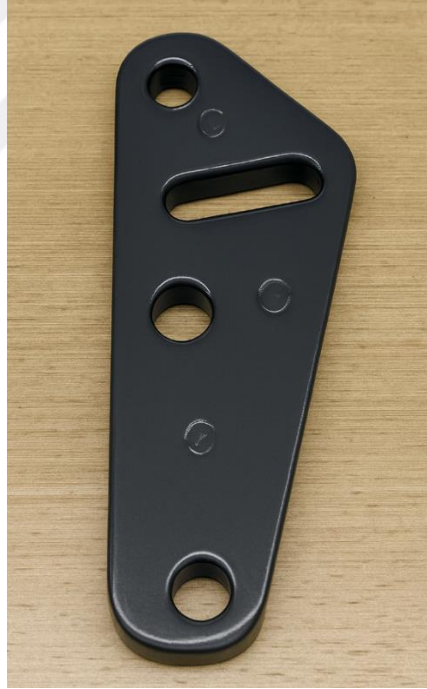
Şekil 3.5 Molibden disülfür katkılı Poliamid 66 malzemesi ile hazırlanan deney numunesi
