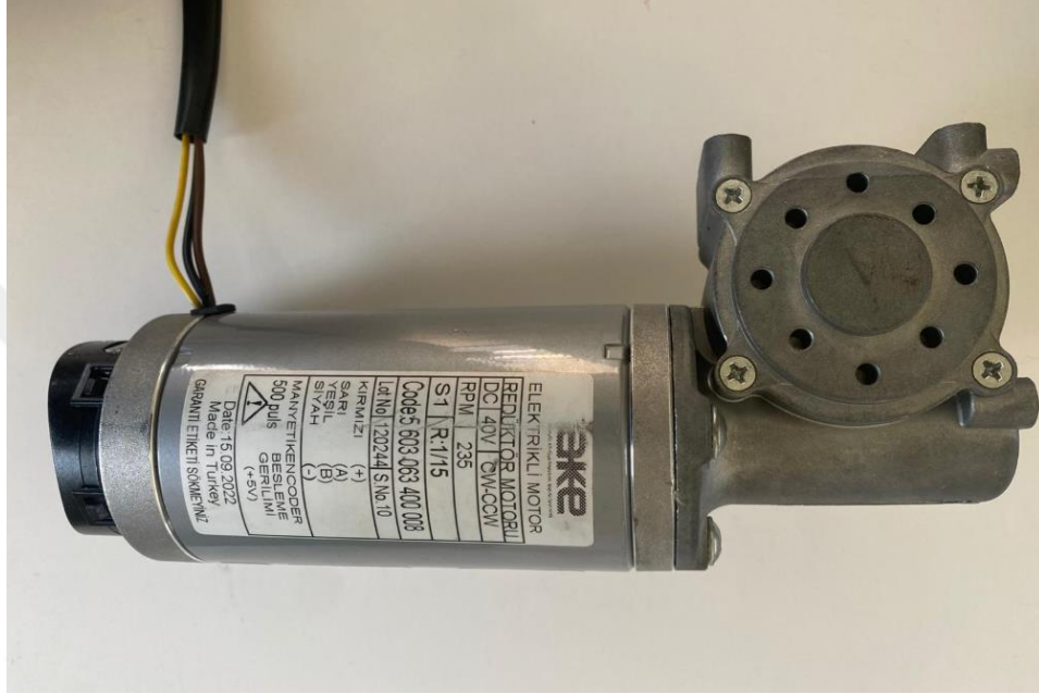
Şekil 3.3 Asansör kapı test mekanizmasında kullanılan motorun görüntüsü
