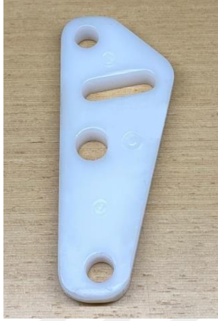
Şekil 3.4 Poliasetal numunesi malzemesi ile hazırlanan deney numunesi
