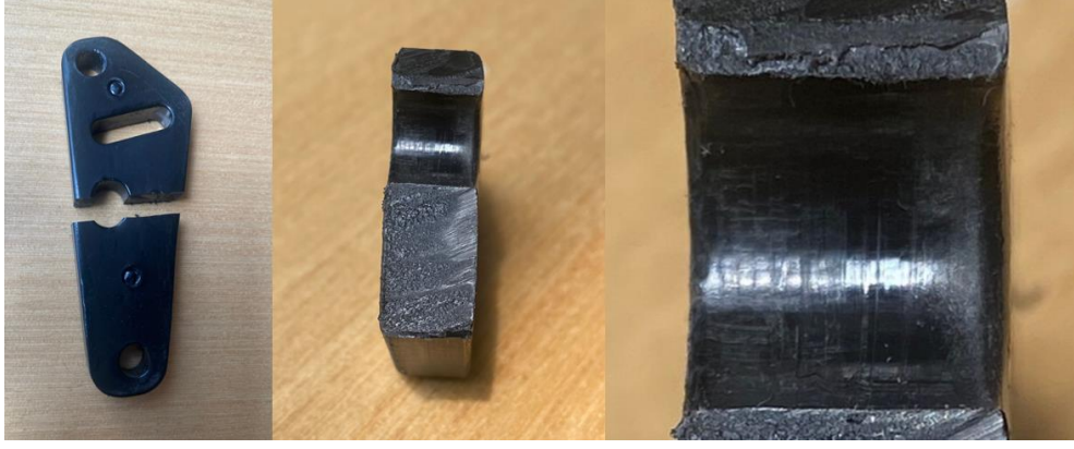
Şekil 4.4 MoS 2 + PA 66 hammaddesinden üretilen numunenin test sonrası kesit görüntüsü
