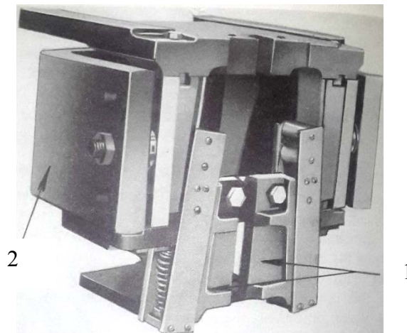
Şekil 2.4 : Esnek kılavuz kelepçe tipi kaymalı güvenlik tertibatı. (1) Konik kamalar. (2) Yay muhafazası.
