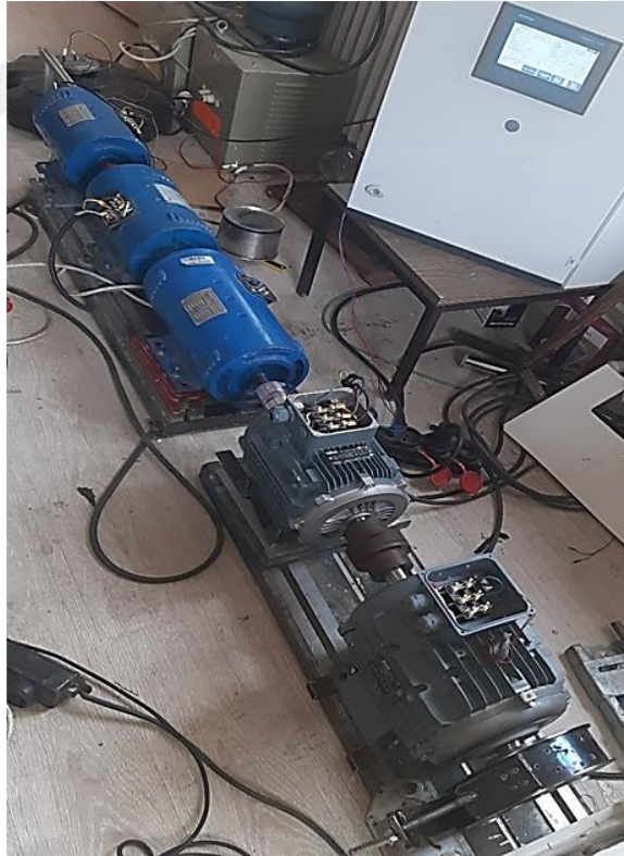
Şekil 3.37. 4kW ve 5,5kW’lık motorlarda elektriksel ve mekanik yükün deney düzeneği bağlantısı
