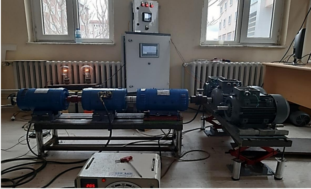
Şekil 3.28. 2,2kW gücündeki motora elektriksel ve mekanik yükün bağlanarak oluşturulan deney düzeneği
