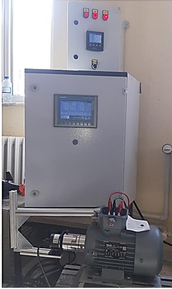
Şekil 3.21. 0,75kW gücündeki motorun miline enkoder bağlantısı ve boşta çalışma deneyleri
