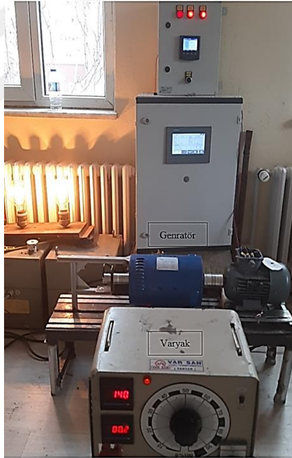
Şekil 3.27. 0,75kW gücündeki motora elektriksel yükün bağlanarak oluşturulan deney düzeneği
