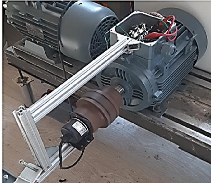
Şekil 3.22. 2,2kW gücündeki motorun miline enkoder bağlantısı ve boşta çalışma deneyleri
