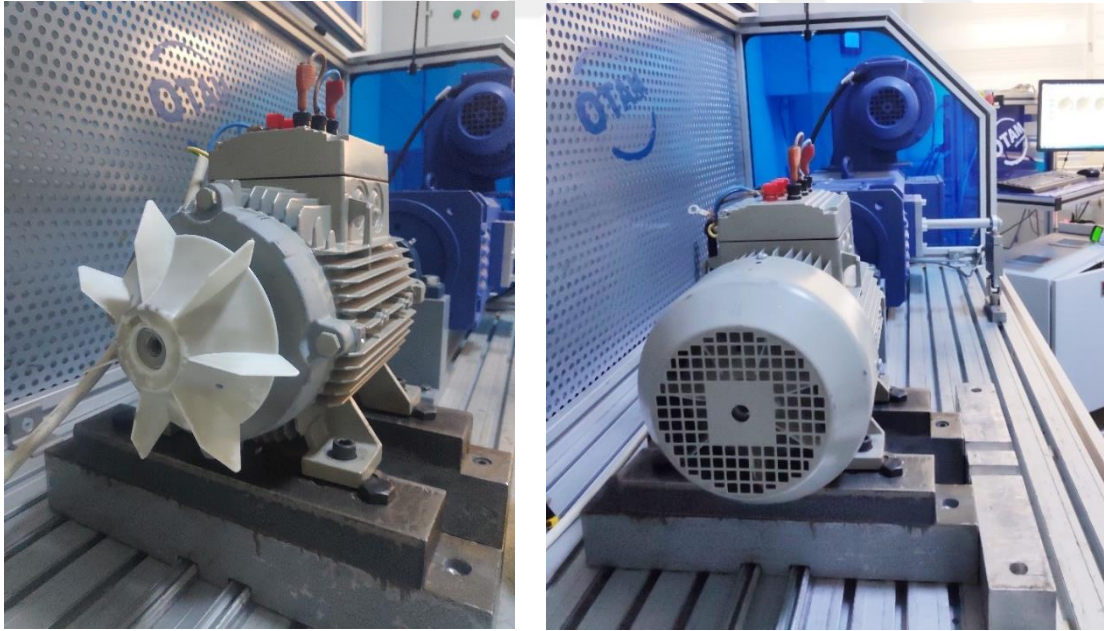
Şekil 5.22. Radyal fan ile motor sıcaklık test düzeneği
