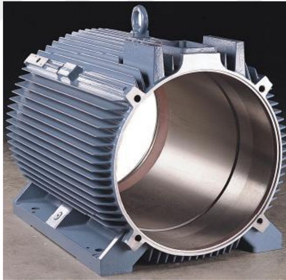
Şekil 3.2. Motor yüzeyini genişletme amacıyla yapılan kaburgalar
