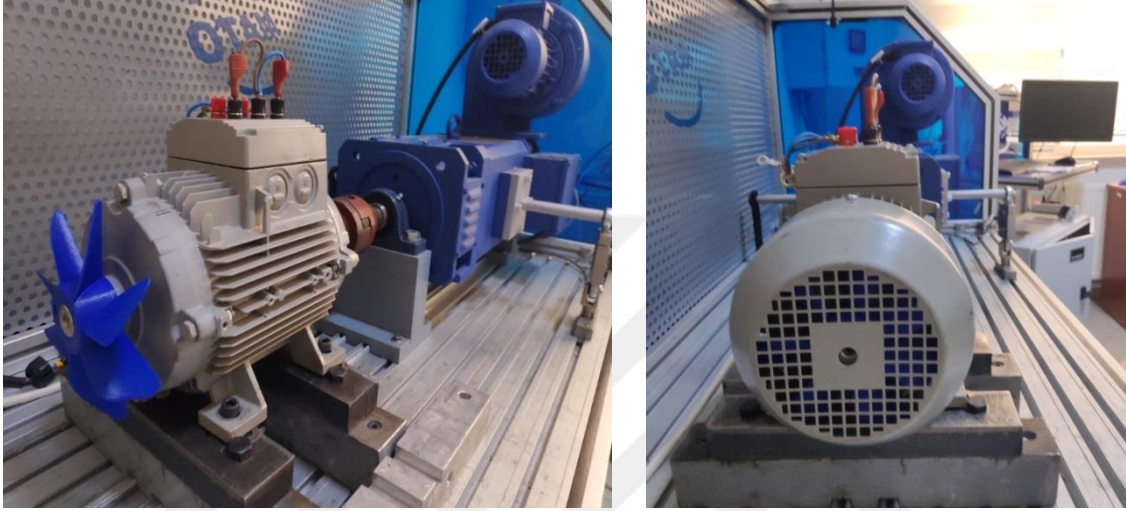
Şekil 5.23. Tasarlanan eksenel fan için test düzeneği
