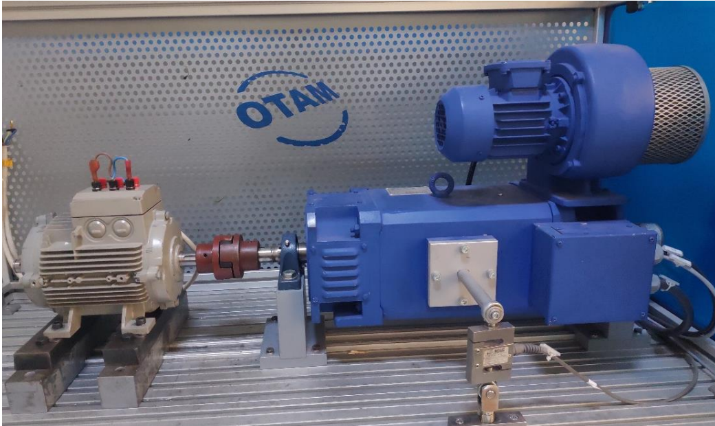
Şekil 5.17. Fansız olarak çalıştırılan motor test düzeneği
