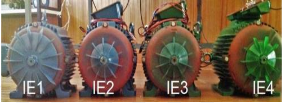
Şekil 4.8. Asenkron motorlar ve soğutma fanları (Roffi & Ferreira, 2017)
