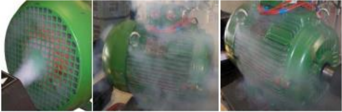
Şekil 4.11. Duman testi radyal fan (orta), eksenel fan (sağ)
