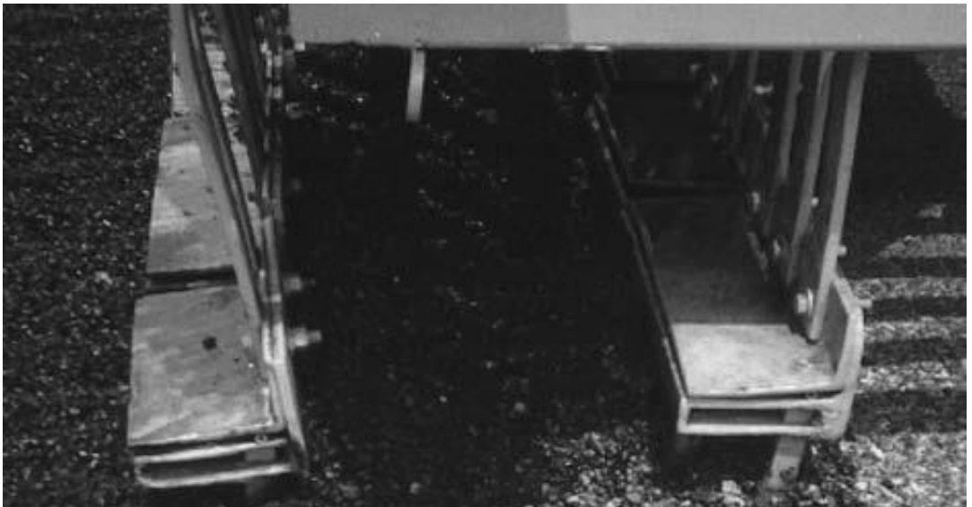
Şekil 2.7. Yüzeysel geri dönüşüm kazıma dişleri (ARRA, 2001).
