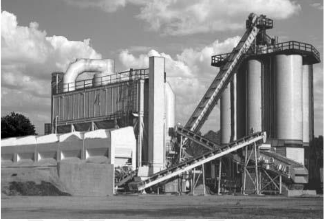
Şekil 2.4. Sıcak geri dönüşüm için RAP beslemeli batch tipi plant (ARRA, 2001).
