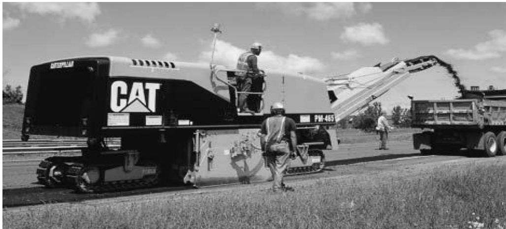
Şekil 2.3. Yarım şerit soğuk düzeltme makinesi (ARRA, 2001).
