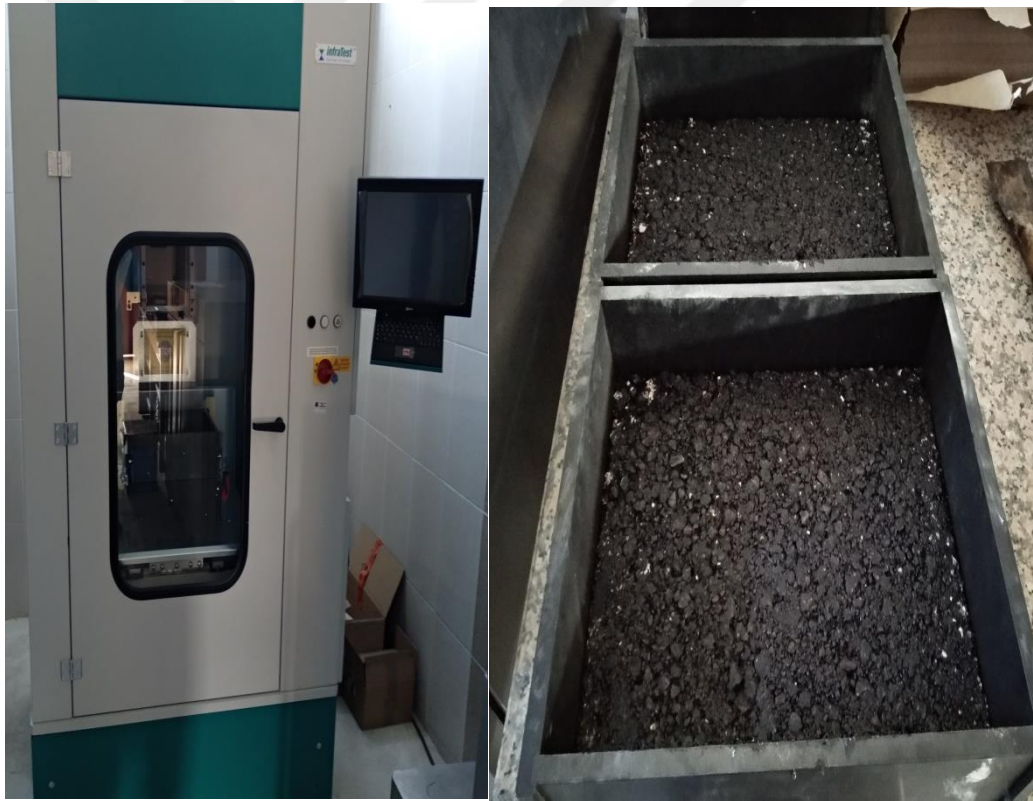
Şekil 4.12. T.İ.O kompaktörü ile numunelerin sıkıştırılması.
