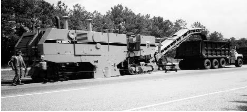
Şekil 2.2. Tipik ön yüklemeli freze makinesi (ARRA, 2001)
