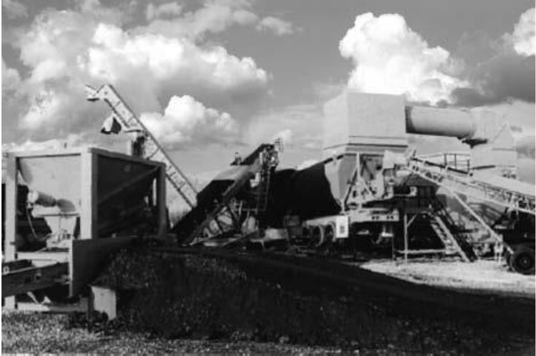
Şekil 2.5. Sıcak geri dönüşüm için RAP'lı durum-mix tipi plant (ARRA, 2001).
