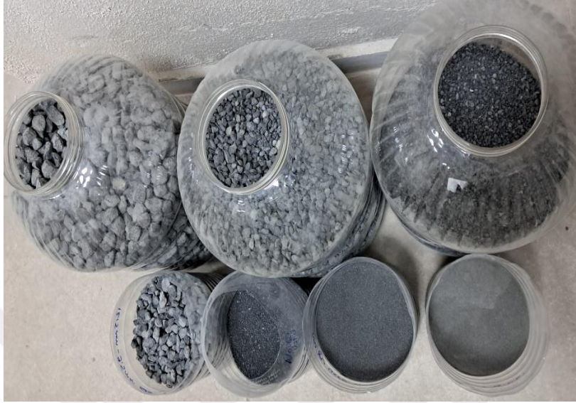
Şekil 3.3. Fonksiyonlarına ayrılmış agrega grupları
