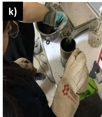
Şekil 3.8. Marshall deneyi aşamaları
